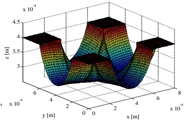
Figure 5.8 : Ménisque à la limite de récession pour un angle limite de  $30^\circ$  ( $H = 2000 \text{ m}^{-1}$ )
