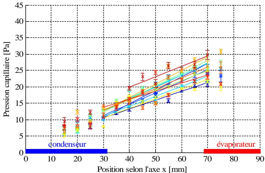
Figure 3.27 : Dispersion de la pression capillaire dans les rainures
