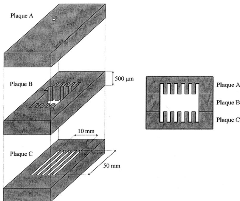
Figure 1.3 : Schéma éclaté de la structure du DTD [25]
