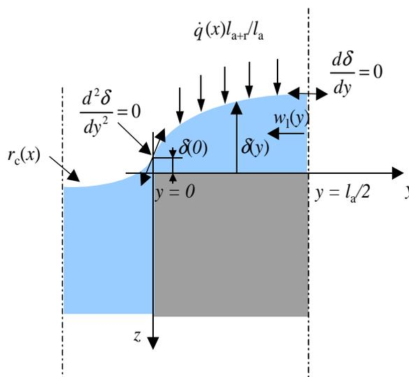
Figure 1.13 : Modèle hydrodynamique du condenseur [10]
