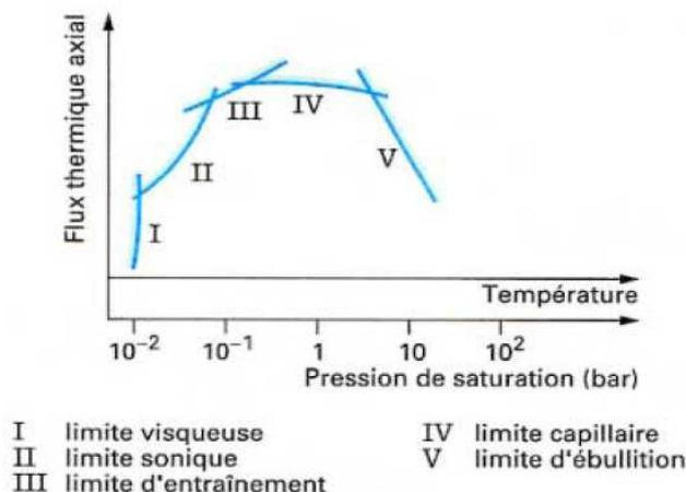
Figure 1.1 : Limites de fonctionnement des caloducs diphasiques à pompage capillaire (Bricard et Chaudourne [12])
