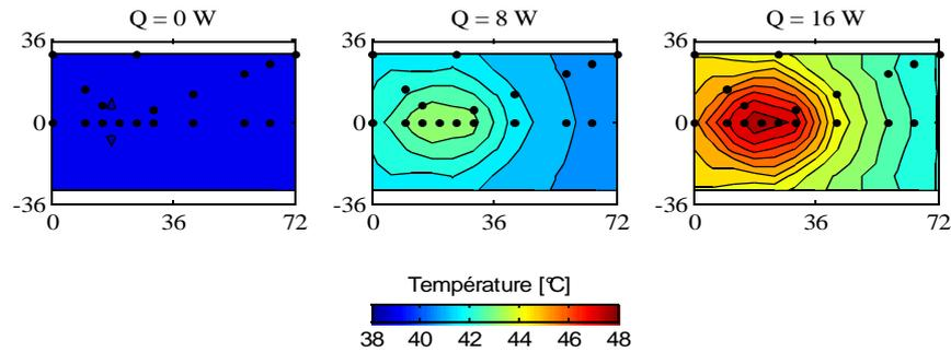
Figure 5.24 : Champs de température mesurés dans le DTD en fonction de la puissance. Les isothermes sont tracées tous les  $0,5^\circ\text{C}$  (méthanol,  $t_r = 12 \%$ )
