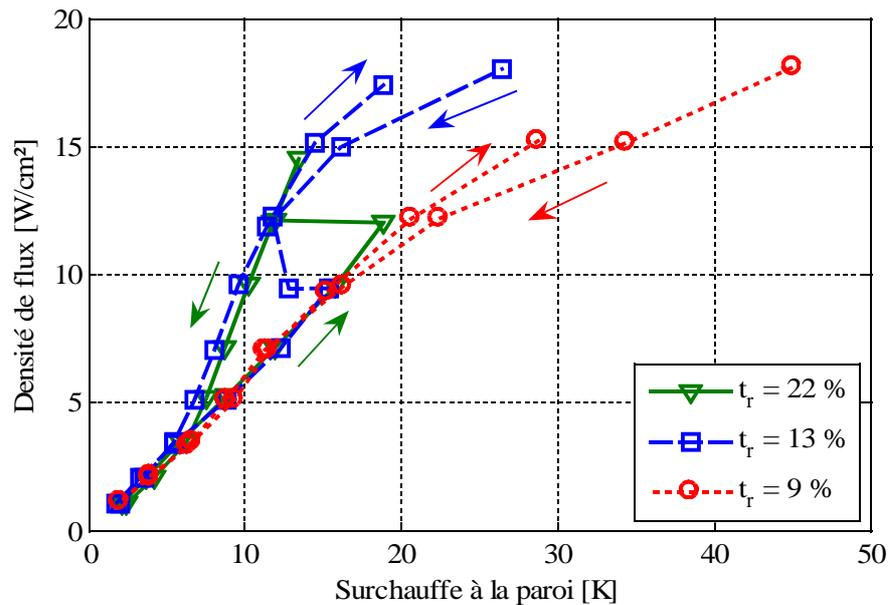
Figure 3.10 : Courbes d'ébullition pour différents taux de remplissage
