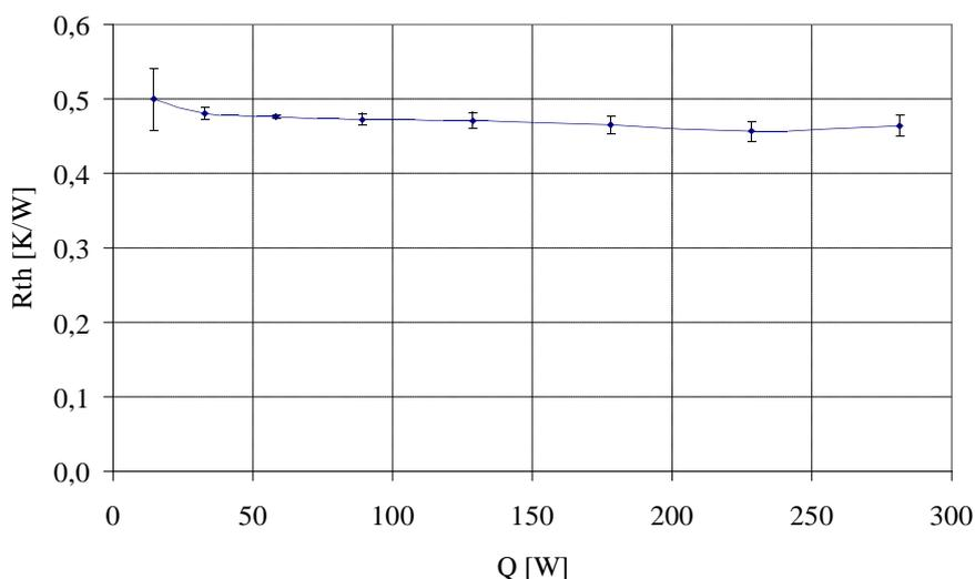
Figure 3.2 : Résistance thermique du diffuseur vide
