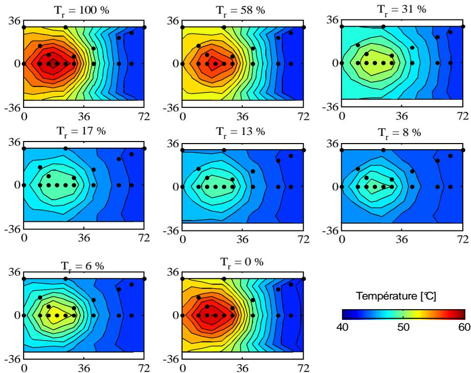
Figure 5.16 : Champs de température mesurés dans le DTD en fonction de la charge. Les isothermes sont tracées tous les  $1^\circ\text{C}$ .
