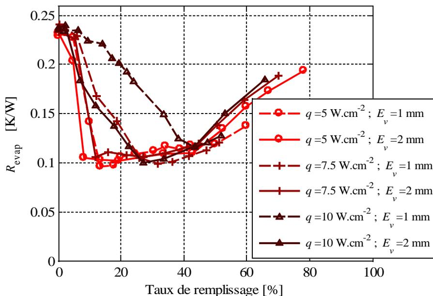
Figure 3.19 : Résistance thermique à l'évaporateur en fonction du taux de remplissage ( $E_v = 1 \text{ mm}$  et  $E_v = 2 \text{ mm}$ )
