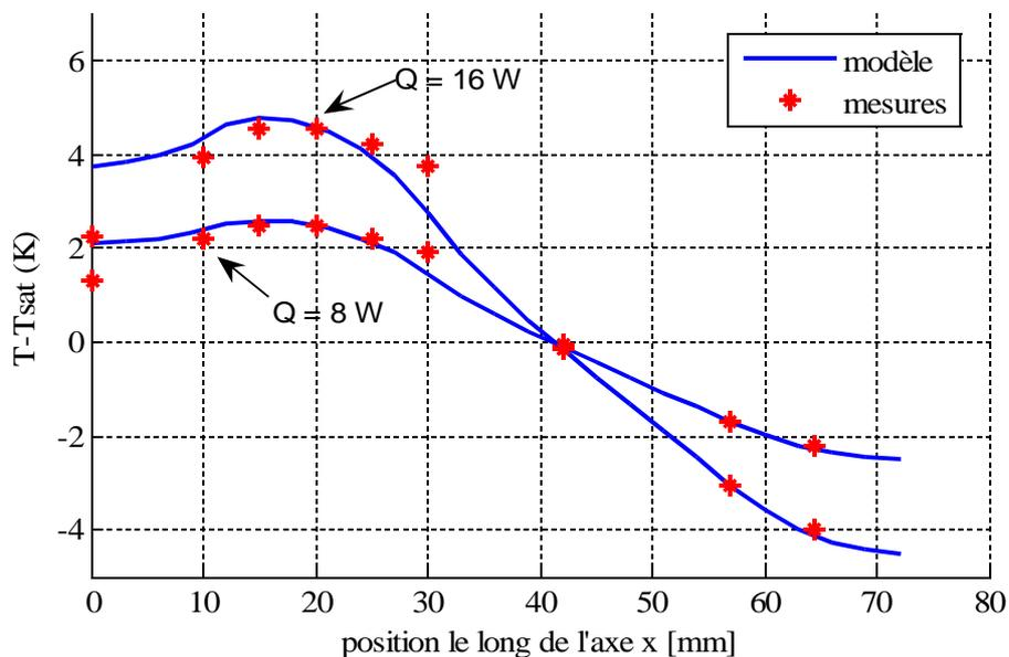
Figure 5.31 : Profils de température le long de la ligne médiane (FC72)
