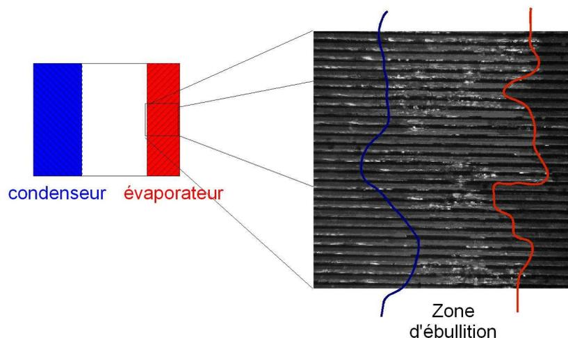
Figure 3.11 : Visualisation de l'assèchement partiel à l'évaporateur
