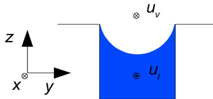
Figure 1.9 : Coupe transversale d'une rainure rectangulaire
