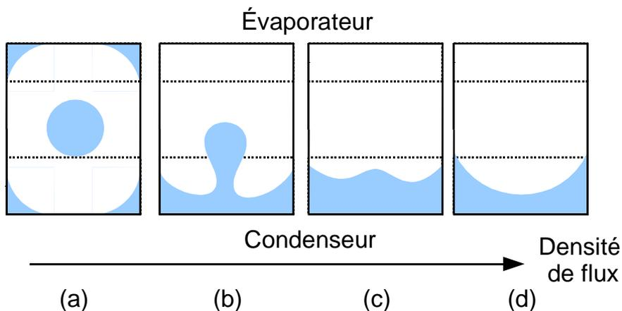
Figure 3.8 : Schématisation des zones noyées pour  $t_r = 22 \%$
