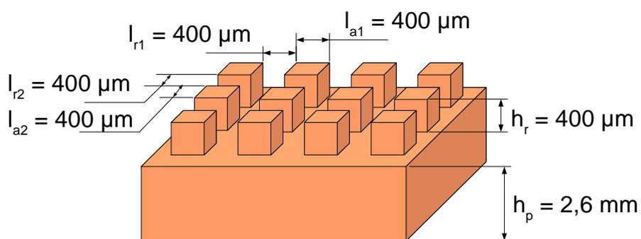
*Figure 2.3 : Structure capillaire du diffuseur à picots*
