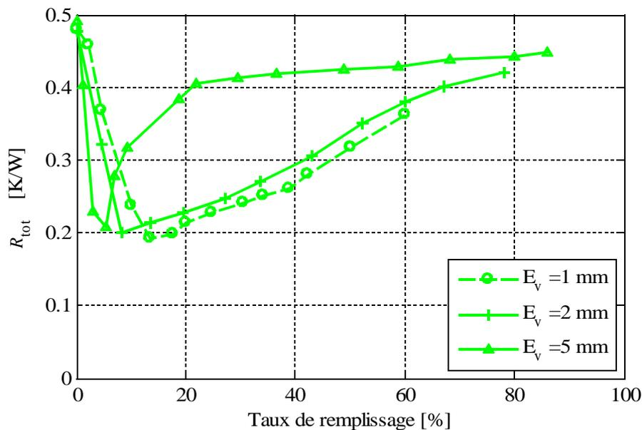
Figure 3.21 : Résistance thermique totale en fonction du taux de remplissage, pour différents espaces vapeur ( $q = 5$  W/cm<sup>2</sup>)
