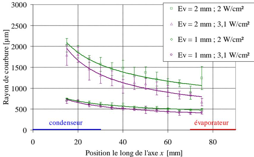
Figure 3.36 : Rayon de courbure des ménisques le long du DTD ( $E_v = 1$  et 2 mm)
