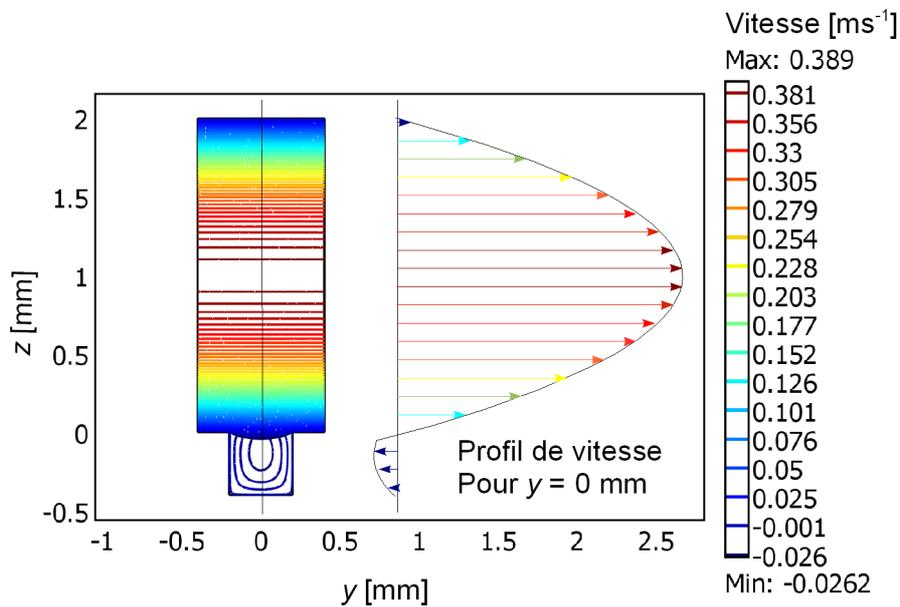
Figure 4.8 : Profil de vitesse dans les canaux
