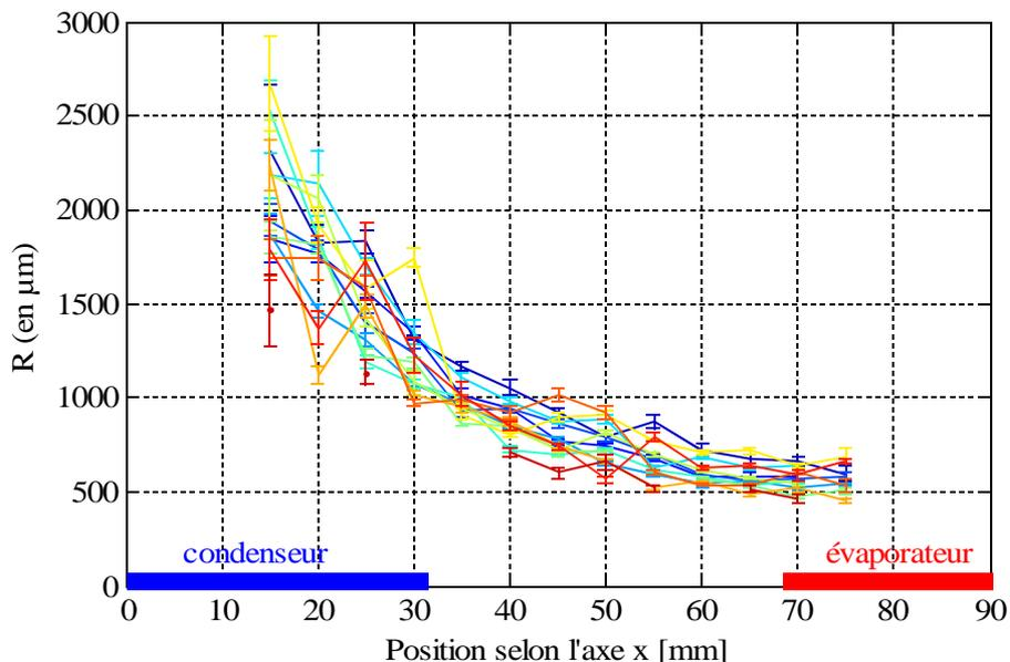
Figure 3.25 : Dispersion des rayons de courbure dans les rainures
