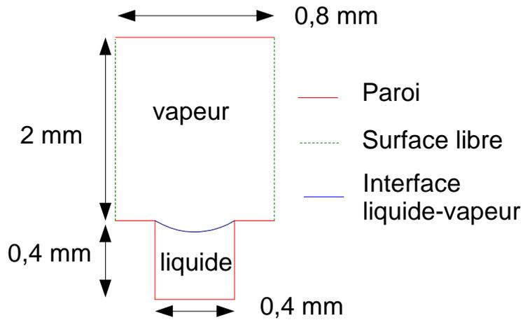
Figure 4.7 : Conditions aux limites du modèle
