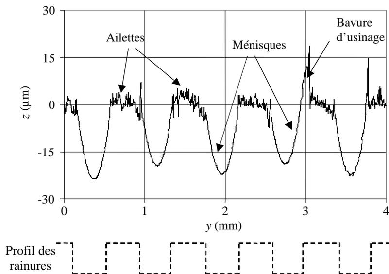
Figure 1.7 : Visualisation des ménisques par microscopie confocale [10]
