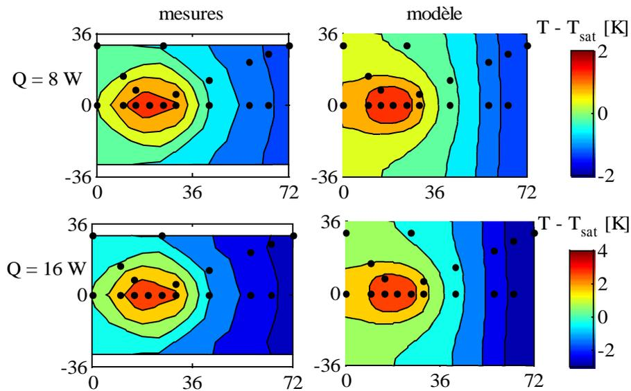
Figure 5.30 : Champs de température dans le DTD rempli avec du méthanol
