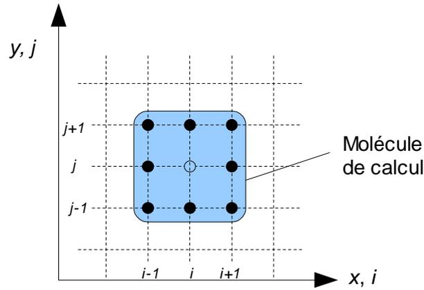
Figure 5.3 : Molécule de calcul du schéma numérique à partir de la définition bidimensionnelle
