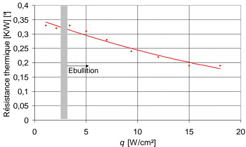
Figure 4.19 : Évolution de la résistance thermique du DTD
