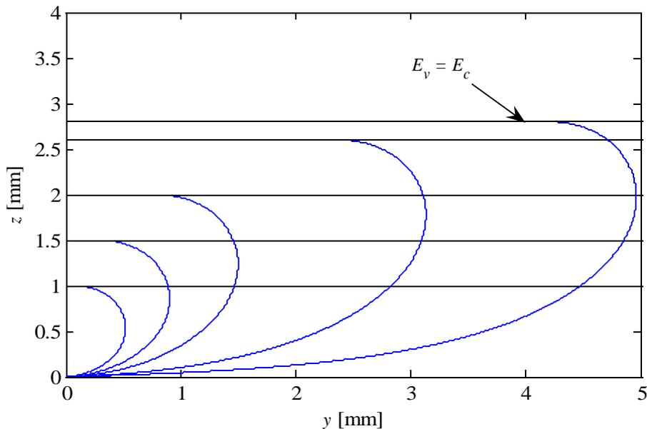
Figure 4.3 : Forme du ménisque sur le bord du DTD en fonction de  $E_v$
