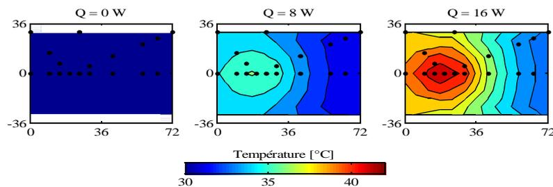
Figure 5.26 : Champs de température mesurés dans le DTD en fonction de la puissance.
