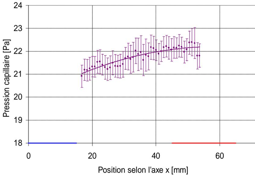
Figure 5.21 : Profil de pression capillaire (méthanol,  $q = 2 \text{ W/cm}^2$ )
