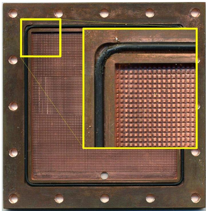
*Figure 2.2 : Photo du diffuseur à rainures croisées*
