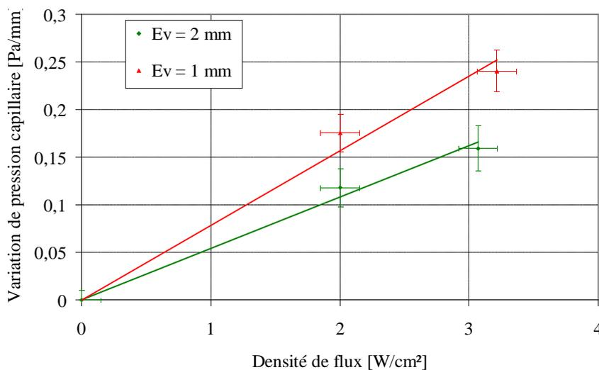
Figure 3.37 : Pertes de charge expérimentales ( $E_v = 1$  mm et 2 mm)
