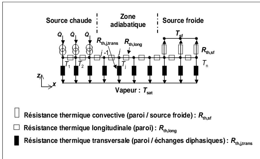
Figure 1.10 : Modèle thermique de Rullière *et al.* [10]
