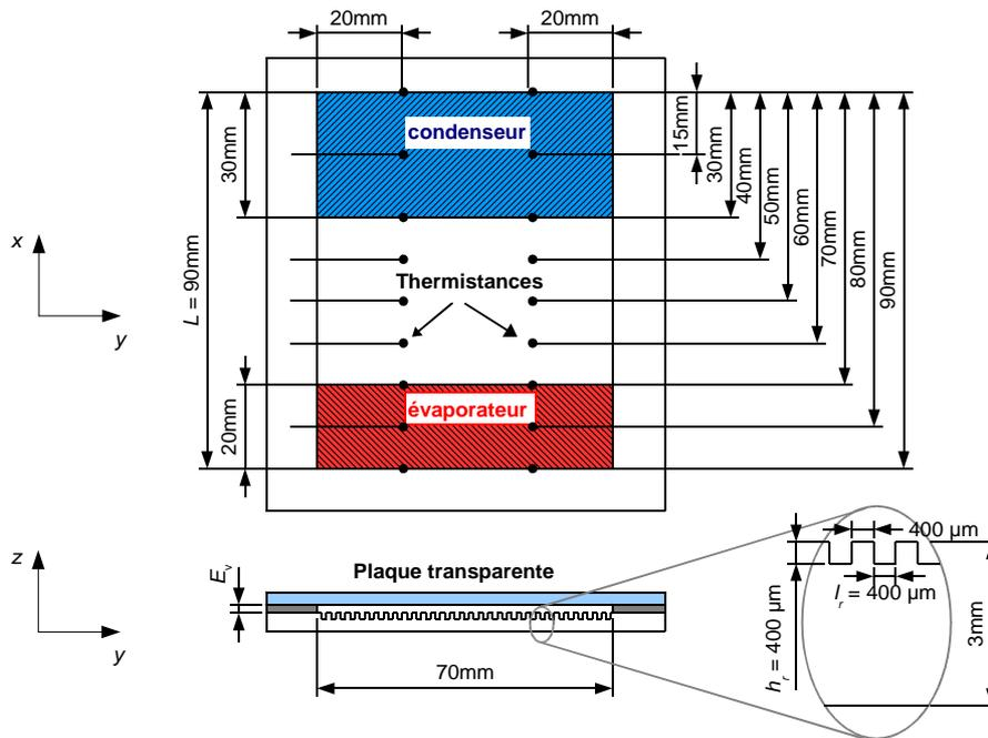
Figure 2.1 : Schéma du DTD à rainures longitudinales
