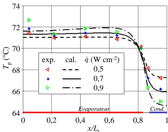
Figure 1.15 : Comparaison des températures mesurées et calculées [10]
