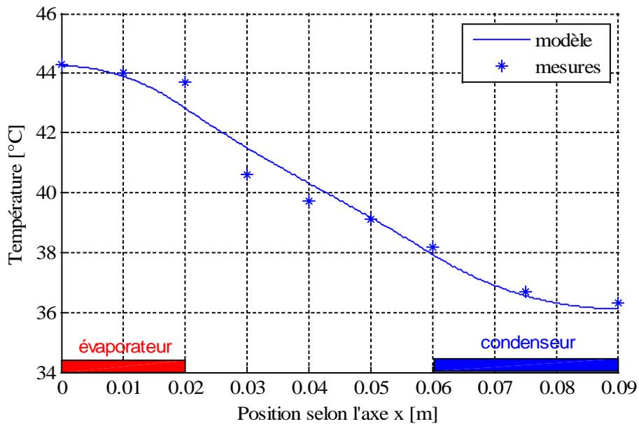
Figure 4.13 : Profil de température le long du DTD
