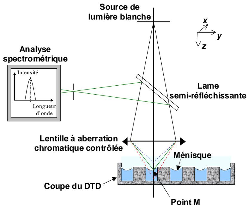
Figure 2.11 : Schéma de principe du microscope confocal
