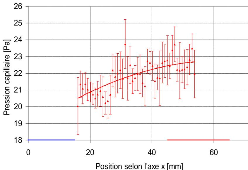
Figure 5.22 : Profil de pression capillaire (méthanol,  $q = 4 \text{ W/cm}^2$ )
