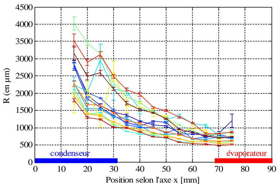
Figure 3.26 : Dispersion des rayons de courbure dans les rainures
