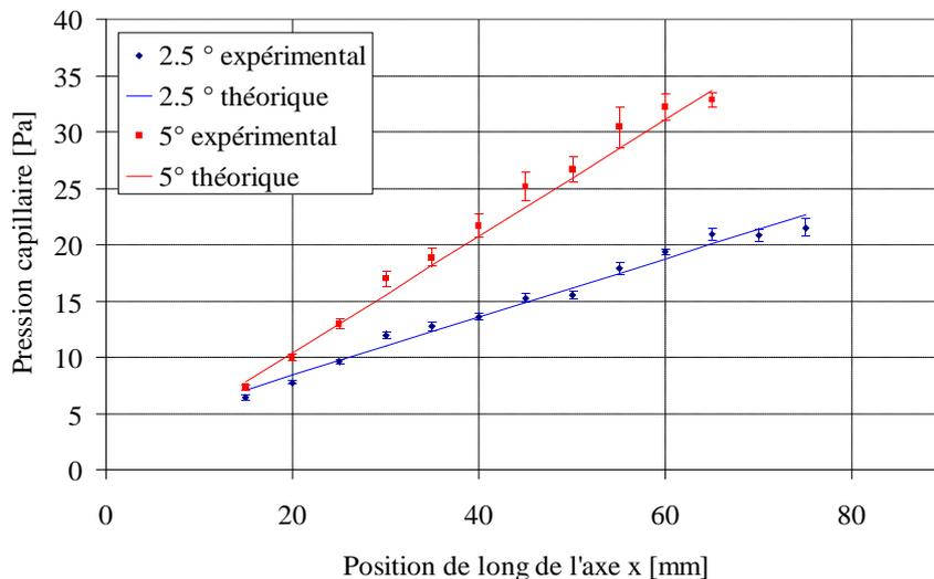
Figure 3.24 : Évolution des pressions capillaires pour un diffuseur incliné au repos
