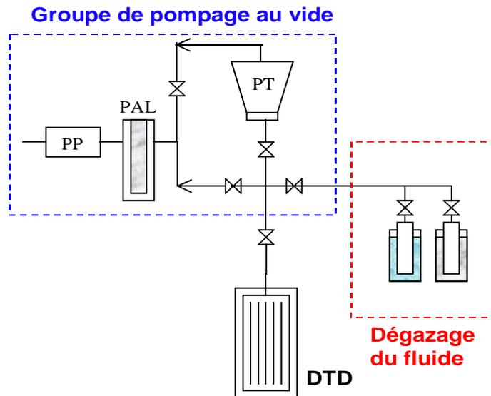
Figure 2.8 : Schéma du banc de remplissage
