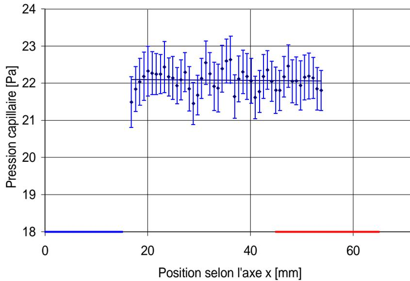
Figure 5.20 : Profil de pression capillaire (méthanol,  $q = 0 \text{ W/cm}^2$ )
