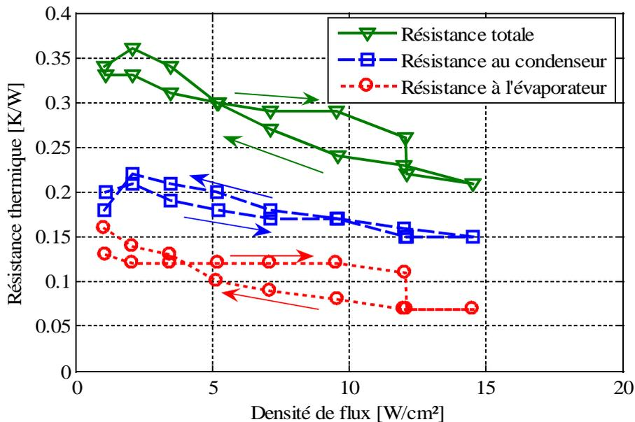
Figure 3.7 : Résistance thermique en fonction du flux thermique
