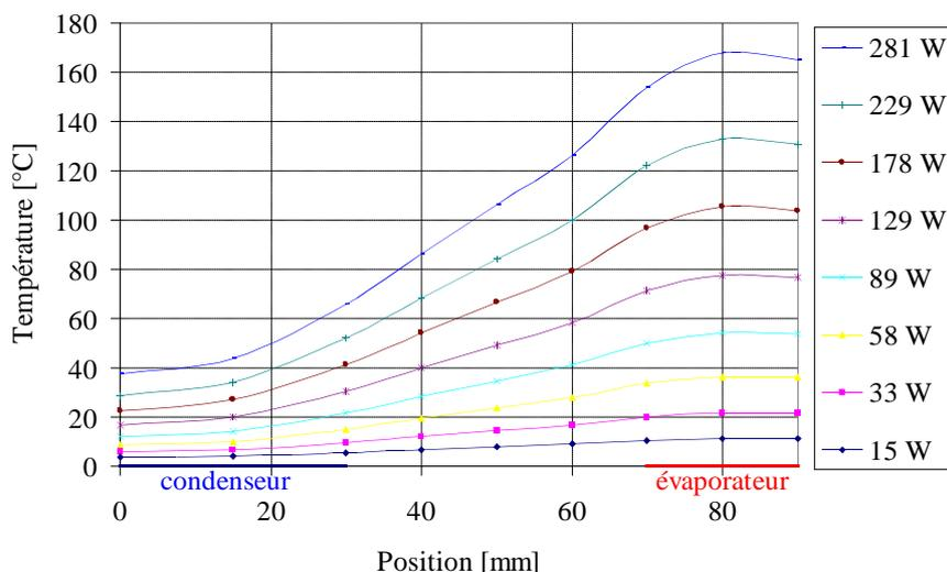
Figure 3.1 : Champ de température dans le diffuseur vide
