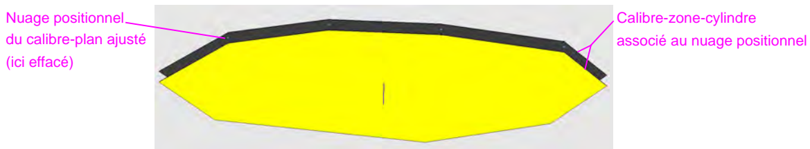
Figure 61 : Nuage positionnel d'un calibre-plan ajusté et Calibre-zone-Dplans associé.
