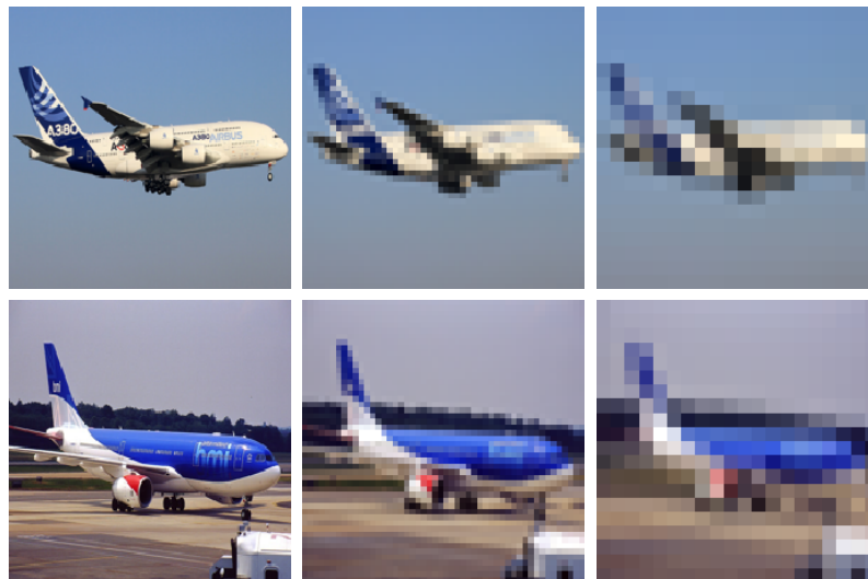
FIGURE 3.6 – Exemples d’images de deux avions Airbus (A380 en haut, A330-200 en bas) à résolutions 200 \times 200 (gauche), 50 \times 50 (milieu) et 20 \times 20 (droite). La dégradation de résolution occulte les détails discriminants qui permettent de distinguer ces classes très proches.
