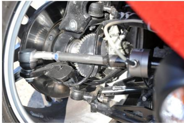
FIGURE 2.12 – Capteur de force sur les biellettes de direction (roue avant droite)
