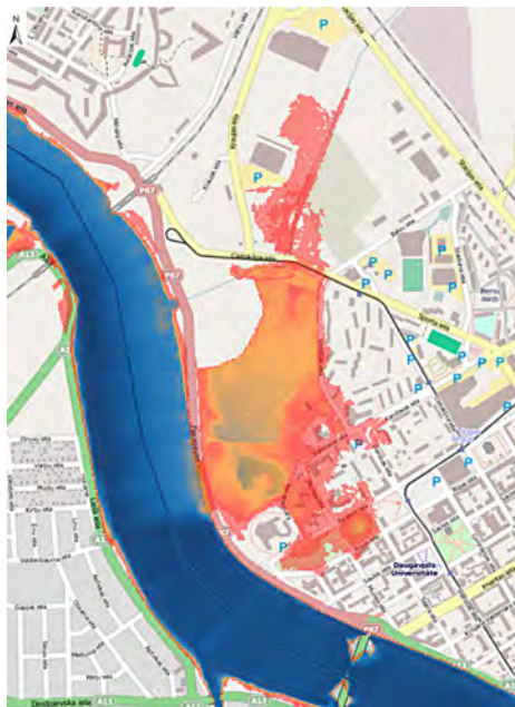
FIGURE 2.23 – Prévisions de zones inondées à partir de LISFLOOD-FP, d'après Merkuryeva et al. (2015)
