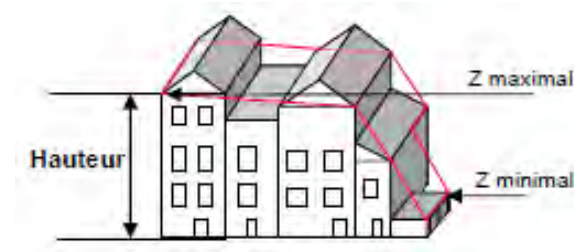
FIGURE 3.36 – Croquis du calcul de la hauteur des bâtiments de la base de données TOPO®, d'après IGN (2011)
