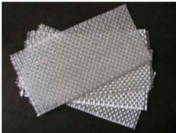
Figure III.1 : Couches de taffetas de fibres de verre utilisées pour la fabrication du matériau étudié.
