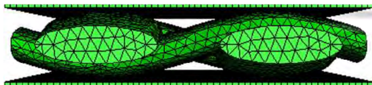
Figure II.14 : Maillage du tissu avant compaction [Lin2008].
