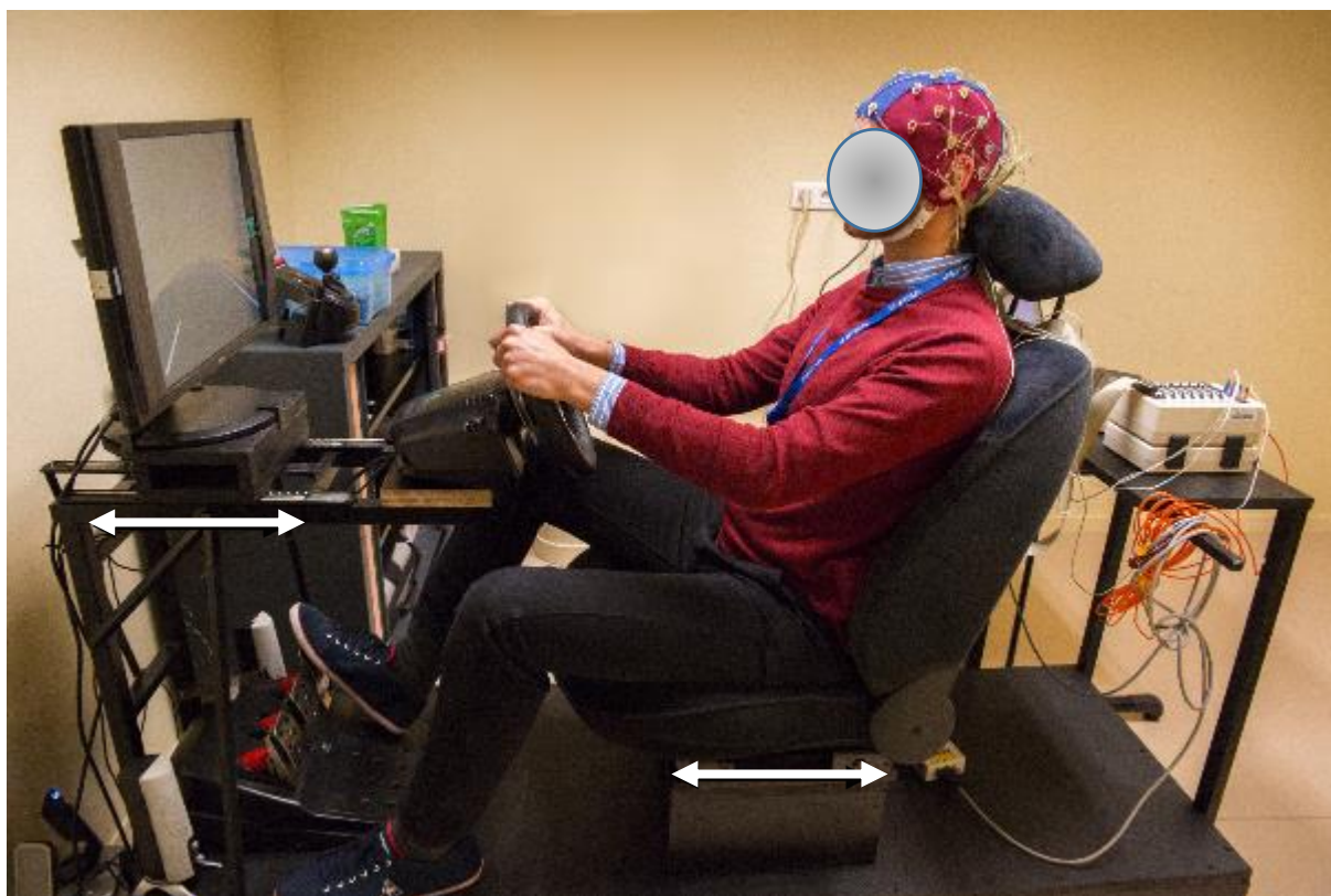
Figure 8 : Installation des participants lors de l'expérimentation sur simulateur réduit (les flèches blanches indiquent les éléments ajustables du poste de conduite)
