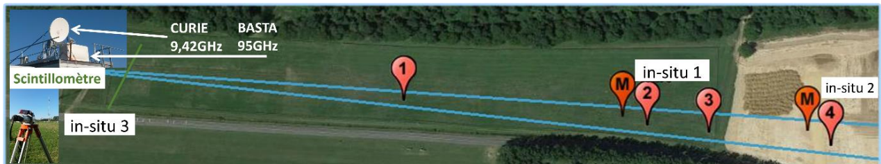
Figure 6-4 : vue aérienne du dispositif expérimental avec les emplacements des mâts supports de cible n°1, 2, 3 et 4, les emplacements des 3 stations de mesure de flux, une photo des deux radars sur le shelter au niveau du SIRTA ainsi qu'une photo et la ligne de déploiement du scintillomètre pendant les périodes d'observations intensives.
