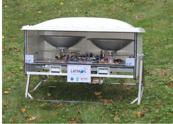
Figure 2-11 : vue de profil du radar BASTA mobile sur sa balancelle. On note les deux antennes l'une émettrice située plus haut que l'antenne réceptrice.
