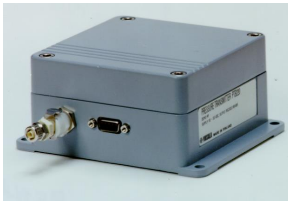
Figure 2-2 : Baromètre électronique (PTB 330) utilisé dans le réseau de Météo-France, source : Météo-France
