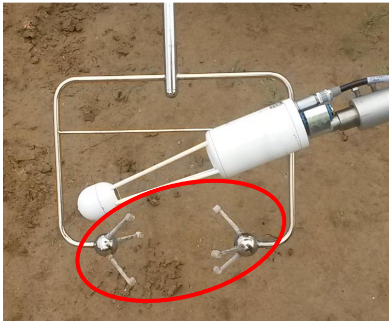
Figure 2-5 : capteur gillh (en base entouré en rouge) et licor (en blanc au centre) lors de leur installation sur le site de la campagne de mesure TEMERAIRE au SIRTA le 9 juillet 2014.
