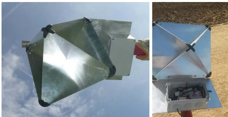
Figure 6-8 : (a) cible fixée sur le haut du mât (vue de face). Le boîtier blanc permet de placer les accéléromètres dans un support étanche. b) Boîtier ouvert : les accéléromètres sont placés au plus près de la cible.
