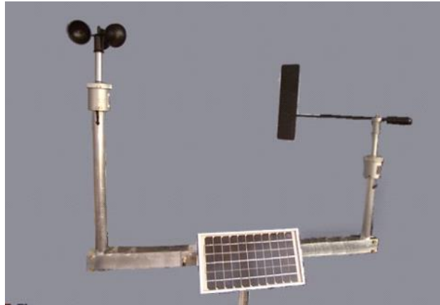
Figure 2-4 : anémomètre et girouette, source : Ecole Nationale de la Météorologie (INP-ENM, Météo-France)
