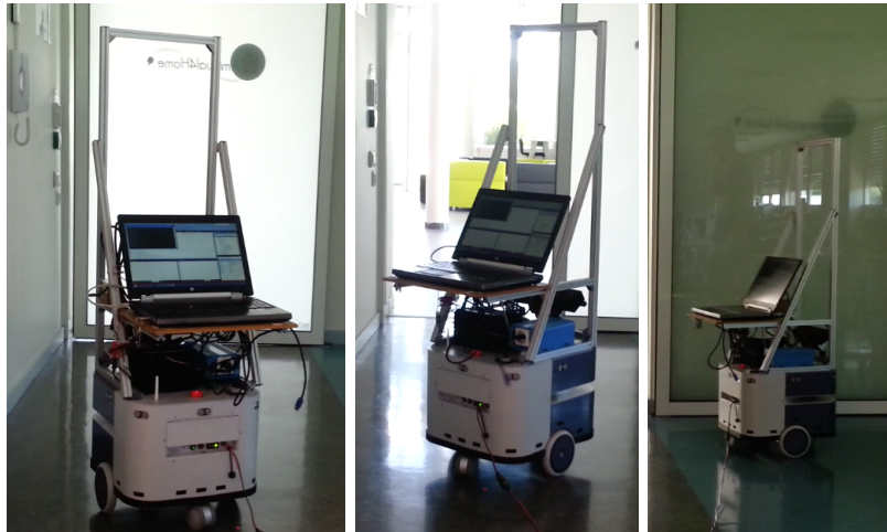
FIGURE 4.11 – Robot autonome évitant les obstacles grâce à la machine bayésienne.
