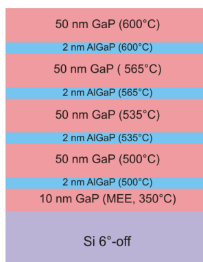
Figure 4 Illustration schématique de l'architecture de la croissance de S1477
