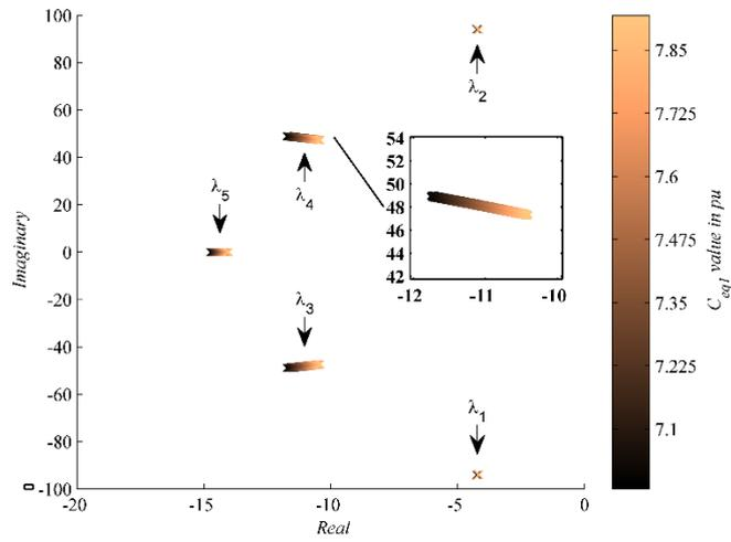
Figure 5.7 Eigenvalue evolution for changing  $C_{eq1} \pm 0.5$  pu .
