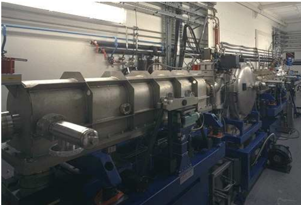
Figure 2 : optique de la ligne D2AM. De droite à gauche, on distingue les enceintes du premier miroir, du monochromateur et du second miroir.
