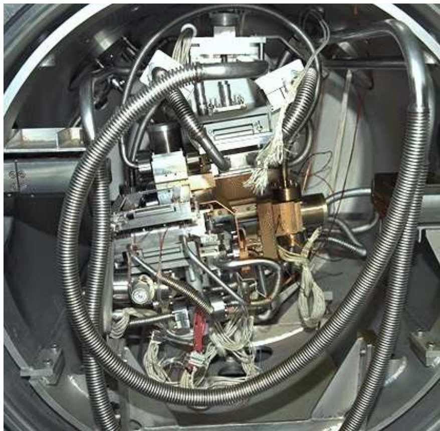
Figure 4 : monochromateur à deux cristaux de la ligne D2AM.
