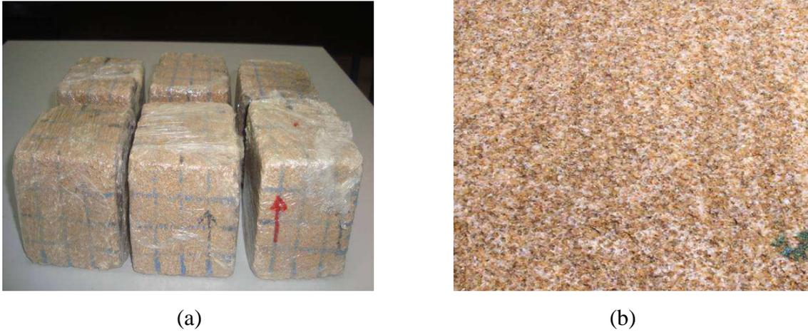
Figure 2.3: (a) Roches calcarénites, (b) Image numérique d'un échantillon calcarénite.
