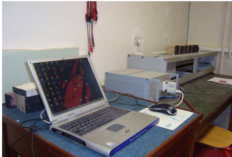
Figure 2.16 : Photographie du montage de mesure de la conductivité thermique par TCS.
