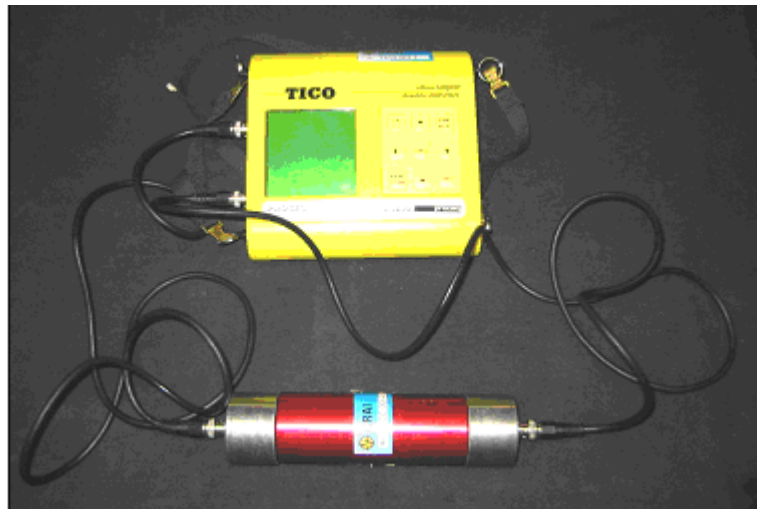
Figure 2.18 : Dispositif utilisé pour la mesure de vitesse de l'onde P : un générateur d'ultrasons avec une fréquence de 54 kHz et transducteurs piézométriques.
