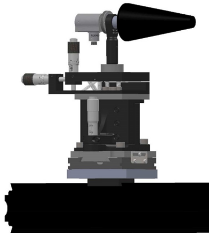
FIGURE 3.16 – Représentation 3D du système de réception incluant le collimateur, le baffle et les platines de positionnement associés ( X, Z, \theta, \phi )
