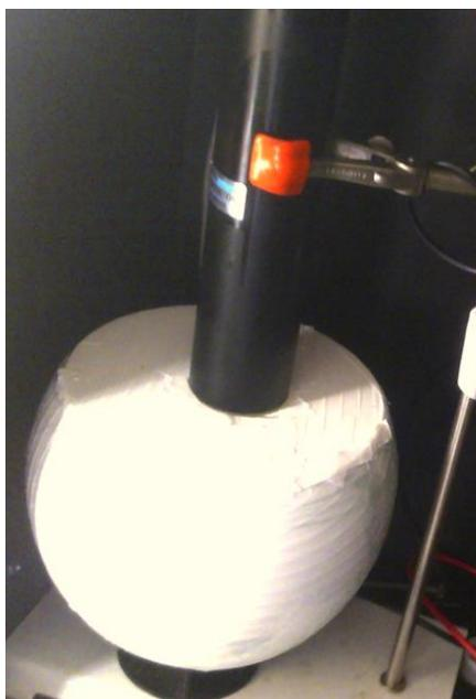
Figure IV.21 : Montage expérimental pour l'acquisition de spectres (matrice de polyvinyltoluène).
