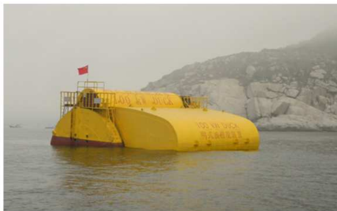
FIGURE 2.37 – Un démonstrateur de 100 kW de la technologie Salter's Duck en Chine en 2013. Source : [62]
