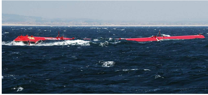
FIGURE 2.18 – L'une des trois Pelamis qui fut installé dans le parc houlomoteur d'Aguçadoura au Portugal.
