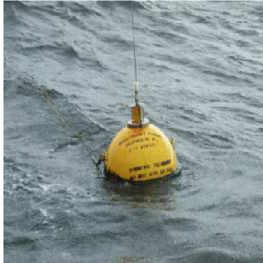
FIGURE 1.7 – Un houlographe : bouée de mesure de la houle en mer.
