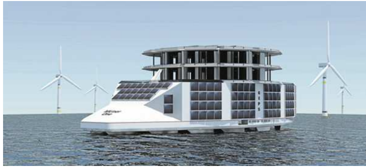
FIGURE 3.24 – La plateforme hybride multi-énergies MLiner de GEPS Techno.
