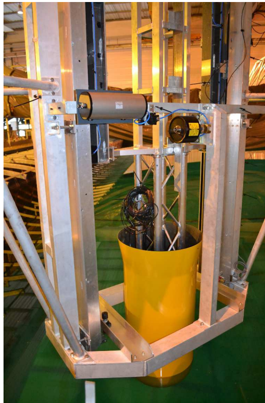
FIGURE 6.5 – Photographie du banc d'essai de stratégies de contrôle de systèmes houlomoteurs développé dans le cadre de la thèse de R. Genest. Le système houlomoteur est de type bouée pilonnante. Il coulisse verticalement le long de deux glissières. Un moteur linéaire et un frein hydraulique permette d'appliquer un contrôle en force et un contrôle par latching [Genest 2014].
