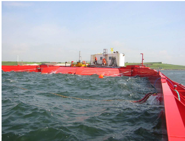
FIGURE 2.17 – Le prototype à l'échelle 1/4.5 du Wavedragon qui fut déployé au Danemark.
