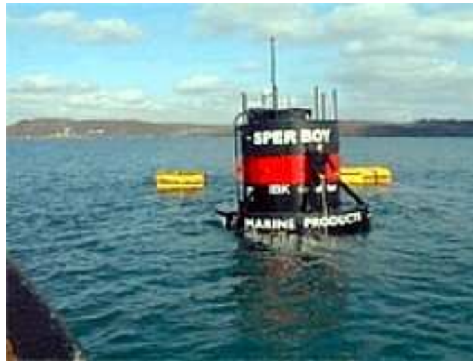
FIGURE 2.19 – Le prototype à l'échelle 1/5 du système à multiples colonnes d'eau oscillante Sperboy au Royaume-Uni.
