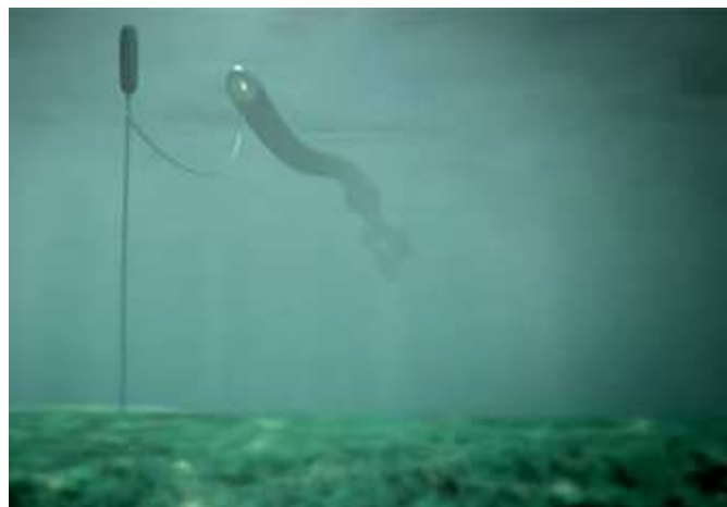
FIGURE 3.19 – Vue d'artiste du système houlomoteur Anaconda.
