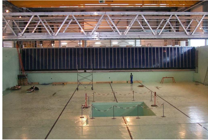
FIGURE 3.8 – Les batteurs volets du bassin de génie océanique de l’Ecole Centrale de Nantes.
