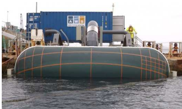
FIGURE 3.18 – Le démonstrateur pleine échelle d'un des modules de l' AWS-III en essai en Ecosse en 2014.
