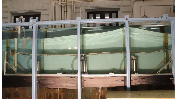
FIGURE 3.21 – La maquette du système Wave Carpet testée à l’université de Berkeley aux Etats-Unis.
