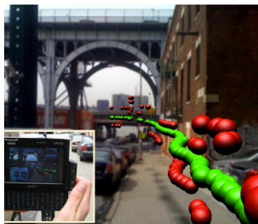
FIGURE C.5 – Utilisation de SiteLens pour l'analyse spatiale des données. Ici, il s'agit de l'analyse de la production de CO sur une rue donnée. [White and Feiner, 2009]
