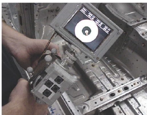
FIGURE 2.12 – Pistolet de soudure intelligent de ARVIKA . [Friedrich et al., 2002]
