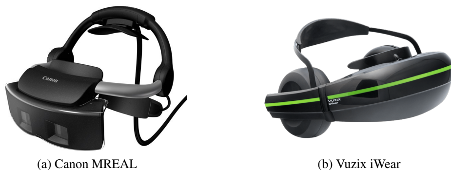
FIGURE 1.7 – Modèles de visiocasques à vision indirecte. 2
