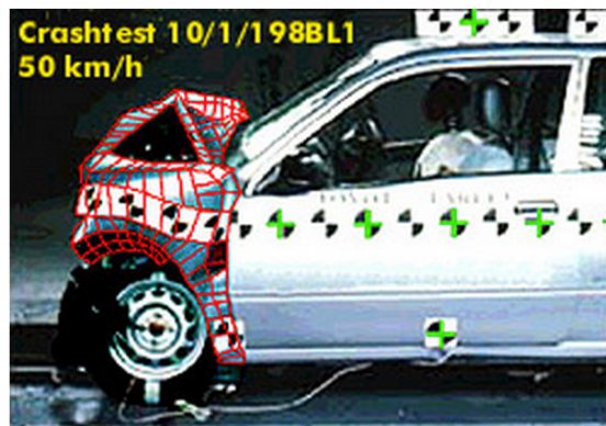
FIGURE 2.15 – ARVIKA dans le cadre d'un test de collision d'une automobile. [Friedrich et al., 2002]
