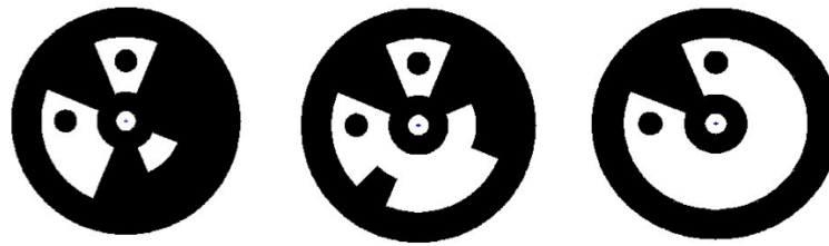
FIGURE 1.20 – Exemples de cibles codées utilisées par InterSense.[Didier et al., 2008]
