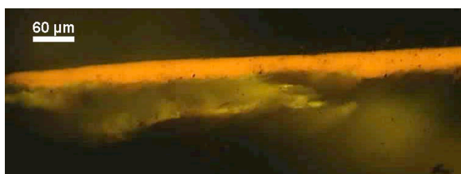
Figure 48 : Coupe stratigraphique du vernis d'une basse de viole (Michel Collichon, 1683, Paris, E.980.2.667) en épifluorescence. Une seule strate, de 20-30 \mu\text{m} d'épaisseur, est visible.
