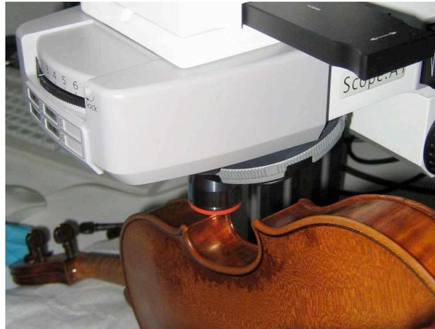
Figure 16 : Un violon ("Longuet", A. Stradivari, Crémone, vers 1692, E.1375) en cours d'observation sous le microscope Zeiss.
