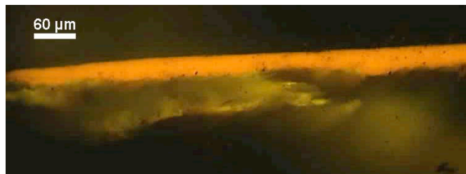
Figure 48 : Coupe stratigraphique du vernis d'une basse de viole (Michel Collichon, 1683, Paris, E.980.2.667) en épifluorescence. Une seule strate, de 20-30 \mu\text{m} d'épaisseur, est visible.
