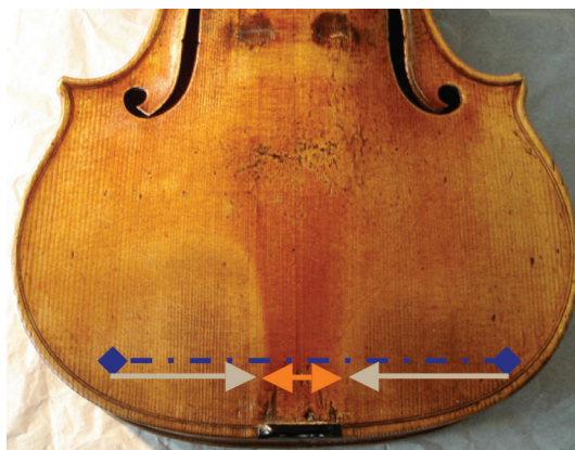
Fig. 2a Localisation de la ligne de points d'analyse sur le violon « Provigny » d'Antonio Stradivari (Crémone, 1716, coll. Musée de la musique, E.1730.1)
