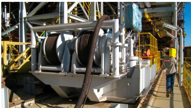
Figure 72: Exemple d'illustration d'un Riser Pull-in System
