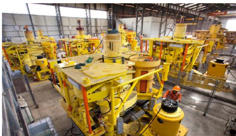
Figure 76: Illustration d'un X-mas Tree du projet Pazflor
