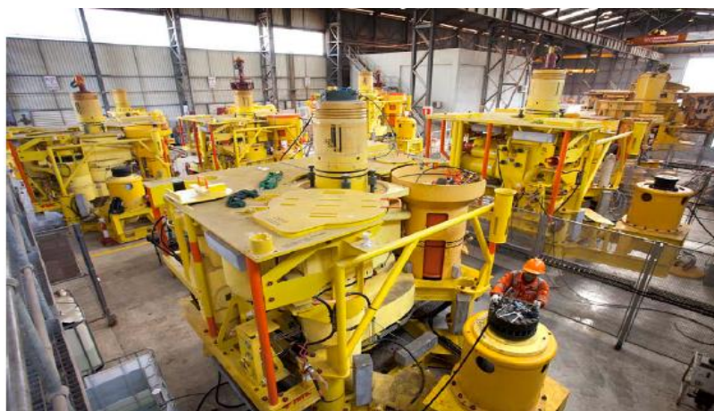
Figure 76: Illustration d'un X-mas Tree du projet Pazflor
