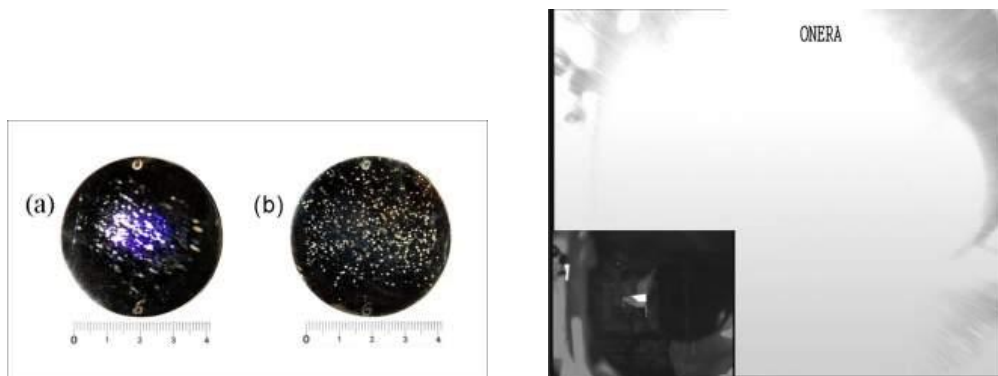
Figure 3.4 : A gauche : Photographie des fenêtres de germanium endommagées par 100 tirs laser à 500 m (a), et 1000 m (b). A droite : Image enregistrée par une caméra CCD lors de son éblouissement. En encart : scène observée par la caméra.
