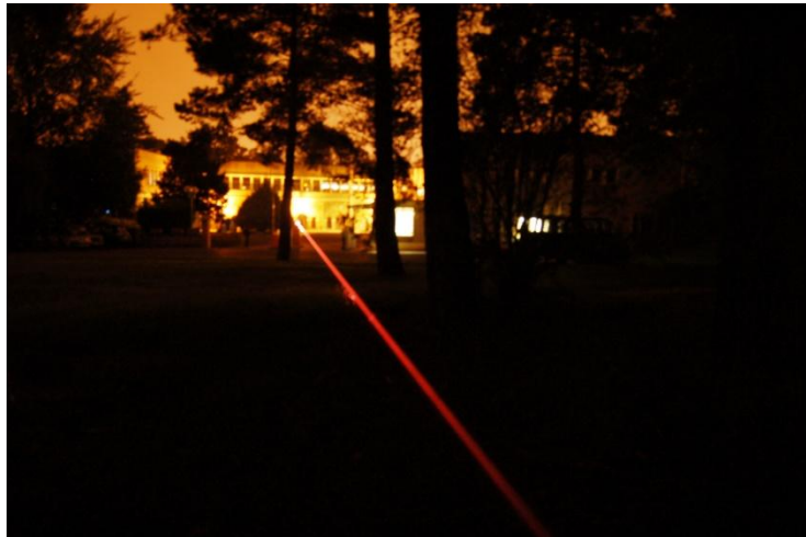
Figure 3.1 : Photographie de la propagation non-linéaire d’un faisceau TéraWatt issue de la chaîne laser ENSTAmobile à 200 m.
