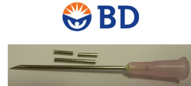
FIGURE 3.8 – Aiguilles hypodermiques utilisées pour réaliser des tubes acoustiques rigides de faible diamètre interne.
