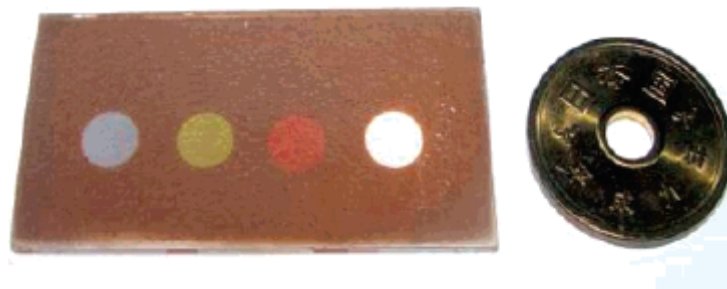
FIGURE 1.15 – Film multicolore Ag-TiO 2 déposé sur substrat de verre. Un masque de diamètre 6 mm a été utilisé pour sélectionner la zone à insoler (image de droite). Chaque spot a été insolé successivement avec une lumière bleue, verte, rouge ou blanche à l'aide d'une lampe de xénon et un filtre UV (bloquant les longueurs d'onde en dessous de 400 nm). Pour chaque spot, la couleur de l'illuminant s'affiche dans la zone insolée [51].
