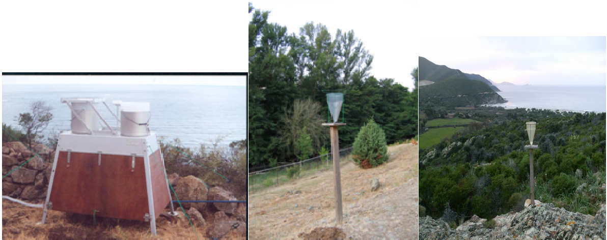
Figure I. 6. Collecteurs atmosphériques des sites Corses, avec de gauche à droite : Ile Rousse, Ponte Leccia et Ostriconi.
