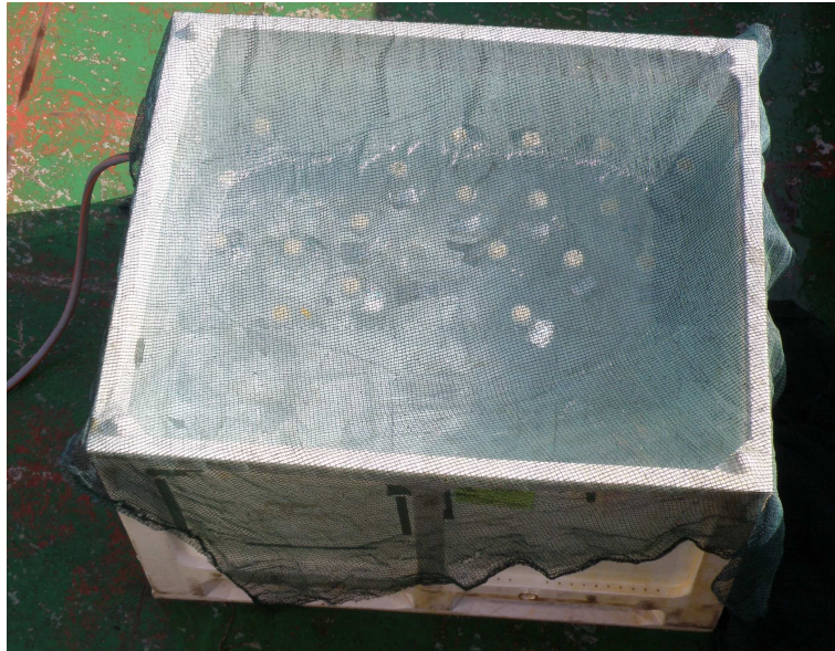
Figure II. 5. Photo du bac d’incubation utilisé pour les expériences de dissolution et fertilisation. On distingue à travers le filtre de lumière les bouchons septum des bouteilles. Sur la gauche du bac, le tuyau installé signale le système de refroidissement.
