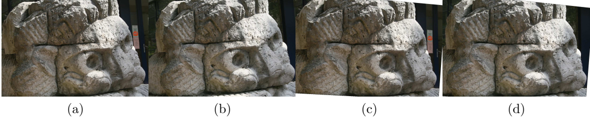
FIGURE 2.4 – Rectification épipolaire d'une paire stéréoscopique. (a) et (b) : Paire originale. (c) et (d) : Paire rectifiée. Les droites épipolaires sont maintenant horizontales et confondues, mais le point principal a été translaté horizontalement. (Code : [30])
