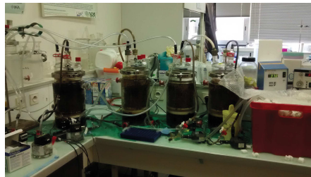
Figure 1.7. Multiple chemostats connected in a laboratory experiment (source Laboratoire de Biotechnologie de l'Environnement, INRA, Narbonne, France ).
