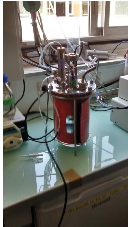
Figure 1.2. Batch bioreactor in a laboratory experiment (source Laboratoire de Biotechnologie de l'Environnement, INRA, Narbonne, France).
