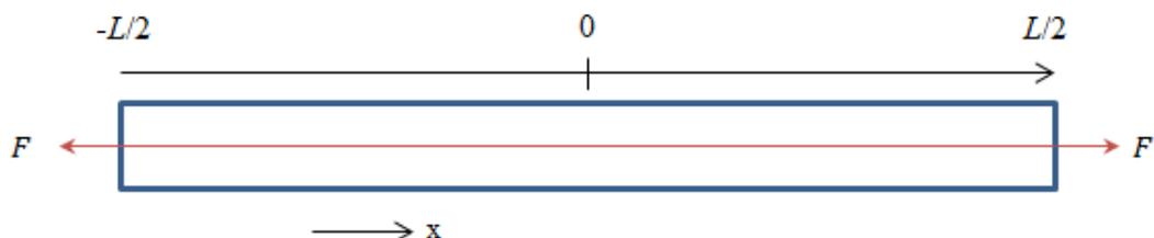
Figure 27. Principe du tirant en béton armé
