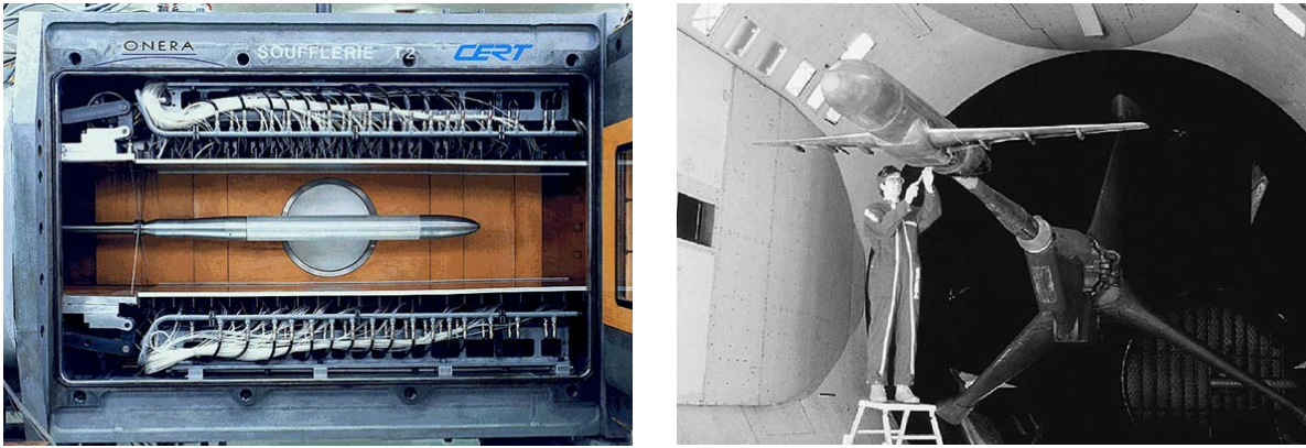
FIGURE 2.9 – Essais en soufflerie de riblets réalisés par l’Onera. (À gauche) Essais transsoniques sur une ogive/cylindre réalisés à la soufflerie T2 de Toulouse pour des nombres de Mach de 0.4 à 0.8 ; (À droite) Essais sur maquette d’A320 à l’échelle 1/11 réalisés à la soufflerie S1 de Modane. Figures extraites de [60].
