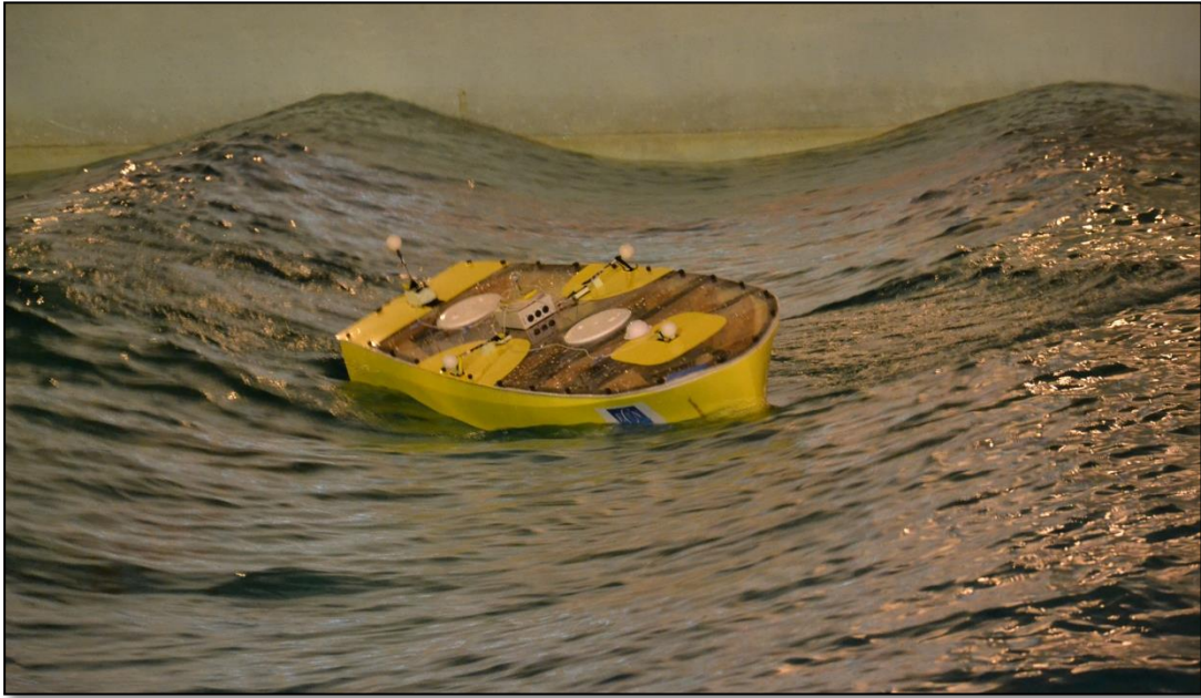
Figure 67 - Maquette lors d'un essai de garde cap en modèle libre, \lambda/L_{pp} = 2 et H/\lambda = 0.1
