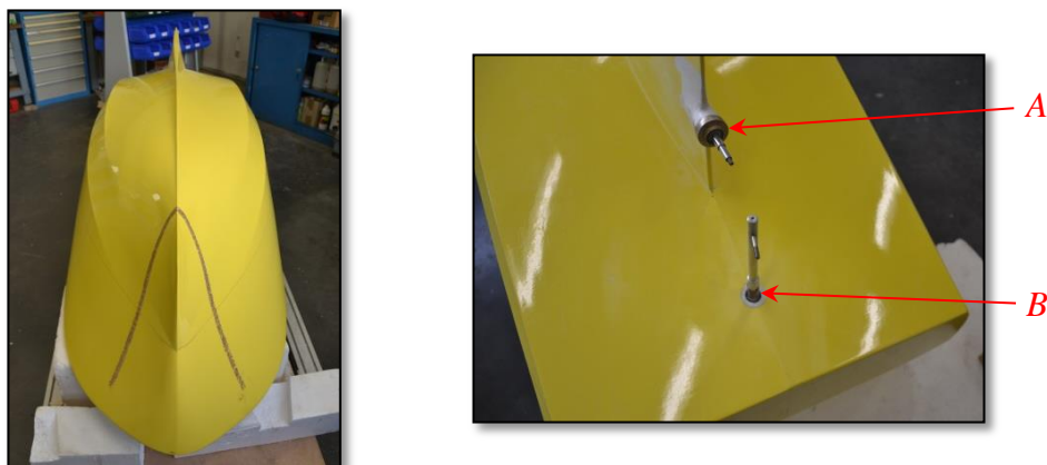
Figure 42 - Pose des bandes de rugosité et perçage des tubes de jaumières et d'étambot (A : tube d'étambot, B : tube de jaumière)
