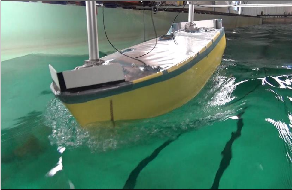
Figure 66 - Maquette lors d'un essai de lacet pur, \lambda/L_{pp} = 1.25 et H/\lambda = 0.05
