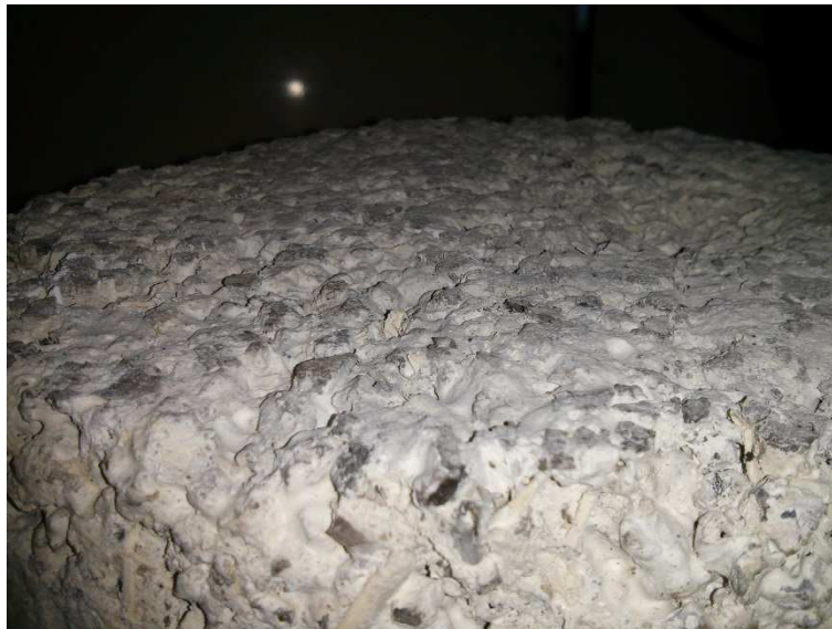
Figure 3-17 : Un échantillon de mélange chaux-liège très rugueux sur lequel nous avons pu mesurer la conductivité thermique au fil chaud en utilisant de la pâte thermique de conductivité 3 \text{W}\cdot\text{m}^{-1}\cdot\text{K}^{-1}
