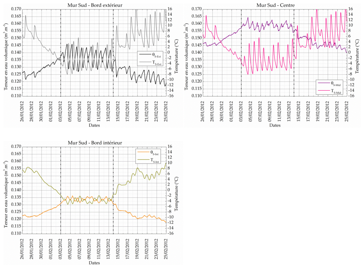
Figure 5-16 : Teneurs en eau mesurées par les CS616 dans le mur sud du 3 au 13 février 2012 (encadrée par les traits mixtes)
