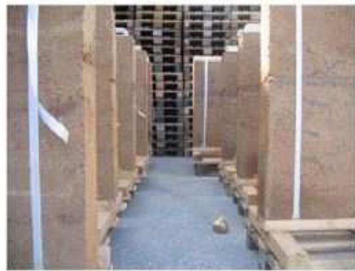
Figure 1-13 : Préfabrication du pisé en usine en Autriche. Photo : M. Rauch
