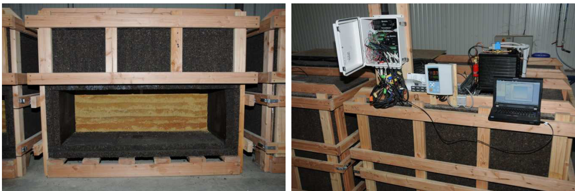
Figure 4-9 : Vue d'ensemble d'un des caissons avec une porte ouverte (à gauche) et la centrale d'acquisition avec le groupe de régulation température/humidité relative (à droite)
