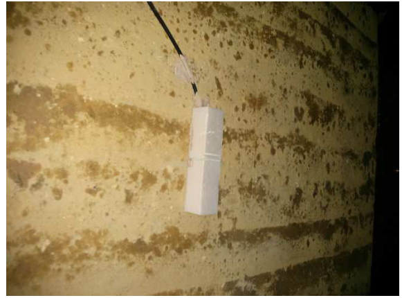
Figure 4-6 : Une thermistance de surface 107 isolée de l'ambiance extérieure et collée sur le mur
