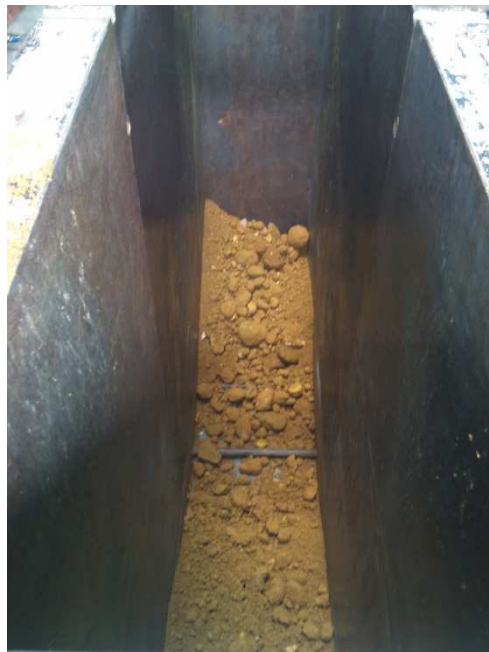
Figure 4-2 : Coffrage pour la réalisation des maquettes de murs en pisé. On peut voir dans le fond les tirants auxquels sont accrochés des U qui permettent de soulever le mur une fois décoffré
