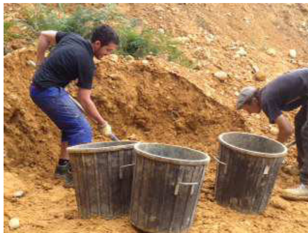
Figure 3-2 : Extraction de la terre de St Antoine l'Abbaye pour la préparation des échantillons à tester
