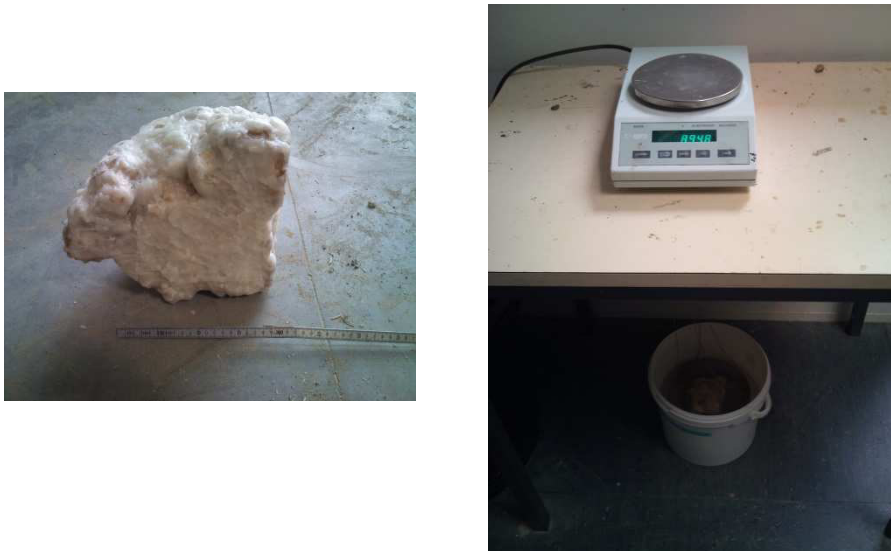
Figure 3-5 : Détermination de la densité d'un échantillon de pisé par pesée hydrostatique. Le plus gros échantillon testé (7kg) enduit de paraffine (à gauche) et le dispositif de pesée (à droite) avec un panier plongé dans l'eau
