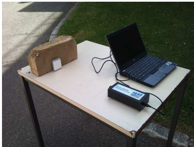
Figure 3-20 : Dispositif de mesure du coefficient d'absorption lumineuse
