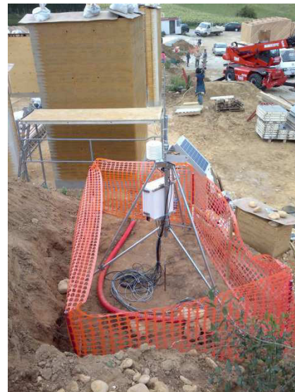
Figure 5-3 : Implantation des capteurs pendant la construction du mur sud/ouest. Passage des câbles des CS616 (en haut à gauche), pose des CS616 sur la partie ouest (en haut à droite), damage sur les CS616 (au milieu à gauche), pose des CS616 modifiées (au milieu à droite), damage sur les CS215 (en bas à gauche) et centrale d'acquisition sur son mat avec le panneau photovoltaïque (en bas à droite)
