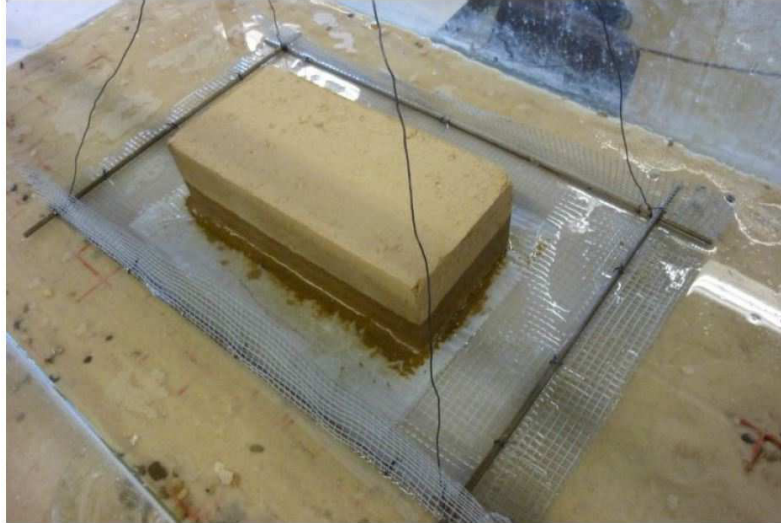
Figure 3-8 : Mesure du coefficient d'absorption d'eau A
