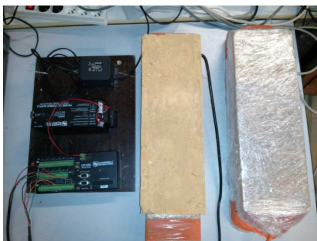
Figure 2-21 : Etalonnage des sondes CS616 et CS650. Le bloc de gauche est nu tandis que le bloc de droite est emballé dans un film plastique
