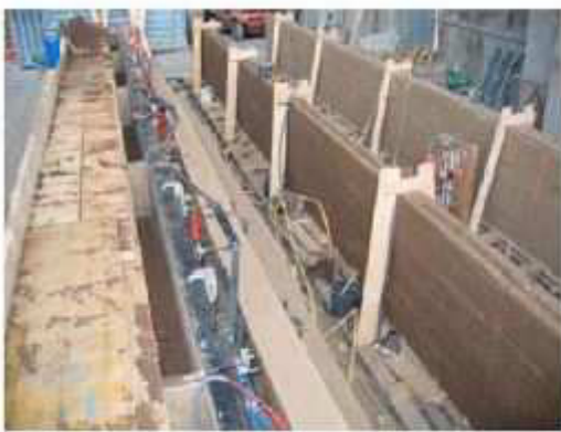
Figure 1-13 : Préfabrication du pisé en usine en Autriche. Photo : M. Rauch
