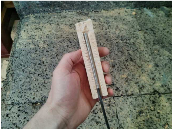
Figure 4-6 : Une thermistance de surface 107 isolée de l'ambiance extérieure et collée sur le mur
