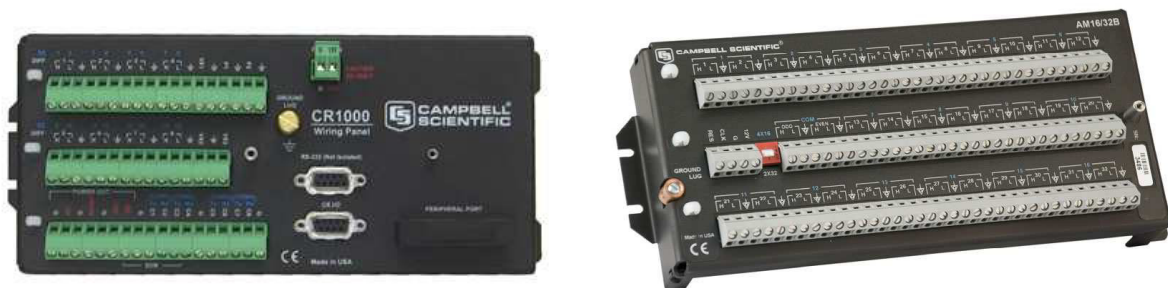
Figure 2-1 : Centrale d'acquisition CR1000 et multiplexeur AM16/32B
