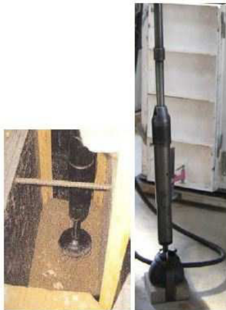
Figure 1-10 : Un fouloir pneumatique non-modifié (à gauche) ainsi qu'un autre muni d'un morceau de bois carré (à droite). Photo : N. Meunier
