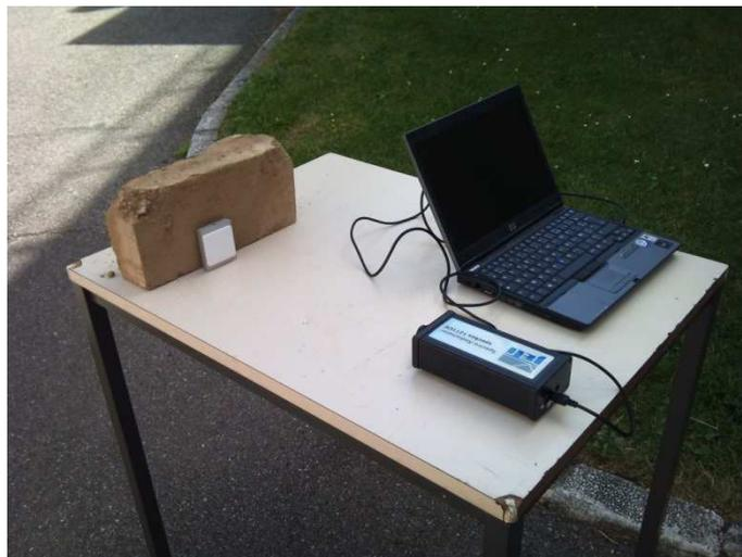
Figure 3-20 : Dispositif de mesure du coefficient d'absorption lumineuse
