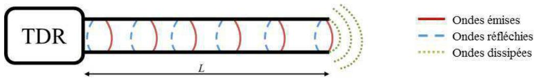
Figure 2-17 : Principe de fonctionnement d'une sonde TDR
