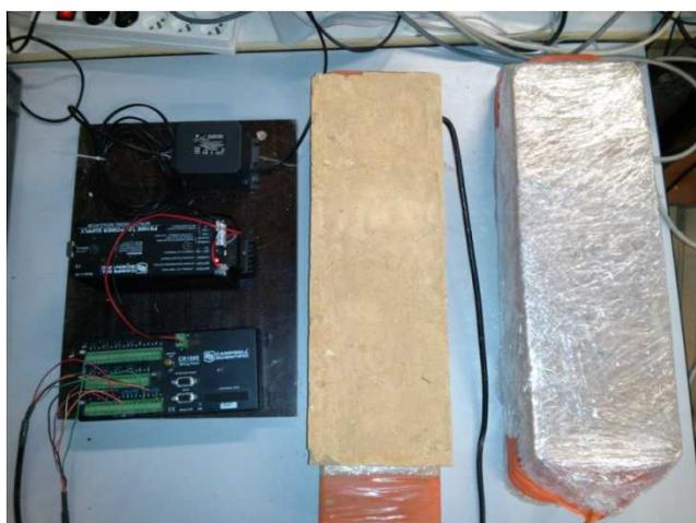
Figure 2-21 : Etalonnage des sondes CS616 et CS650. Le bloc de gauche est nu tandis que le bloc de droite est emballé dans un film plastique
