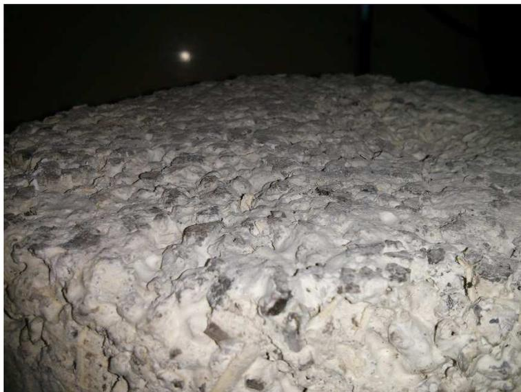
Figure 3-17 : Un échantillon de mélange chaux-liège très rugueux sur lequel nous avons pu mesurer la conductivité thermique au fil chaud en utilisant de la pâte thermique de conductivité 3 W.m<sup>-1</sup>.K<sup>-1</sup>
