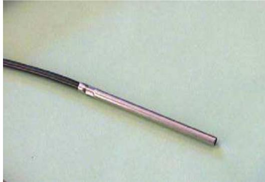
Figure 2-14 : Capteur de température 107
