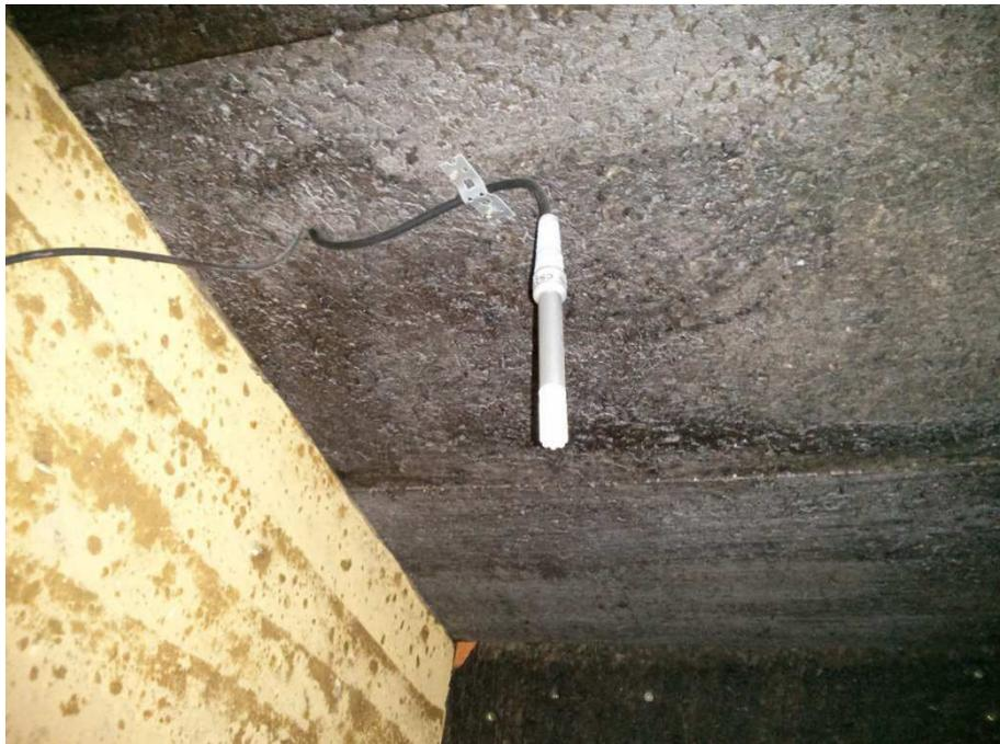
Figure 4-7 : Mesure de la température et de l'humidité relative dans l'ambiance avec une sonde CS215
