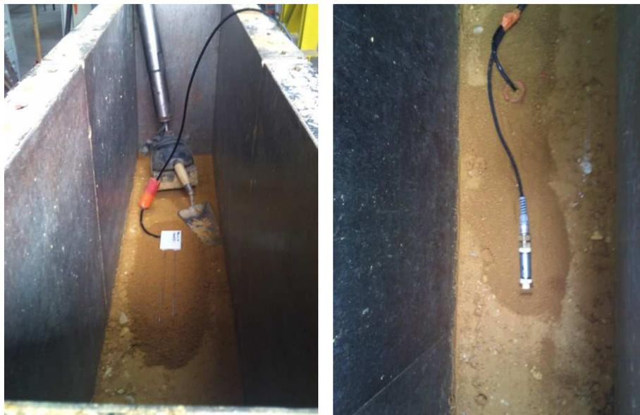
Figure 4-5 : Placement de la sonde CS616 (à gauche) et de la sonde CS215 modifiée (à droite) dans un mur de 30 cm d'épaisseur. Elles sont placées puis recouverte de 1 cm d'épaisseur de terre tamisée pour éviter la présence immédiate de gros granulats qui pourraient les endommager pendant le compactage
