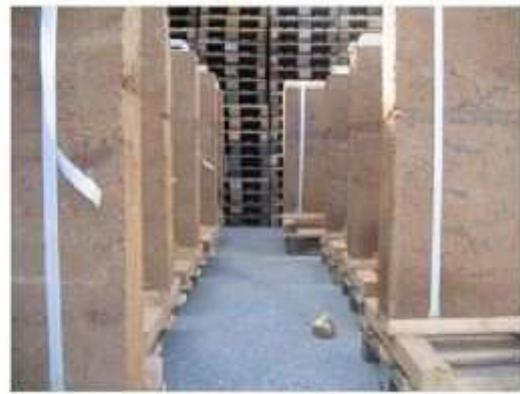
Figure 1-13 : Préfabrication du pisé en usine en Autriche. Photo : M. Rauch
