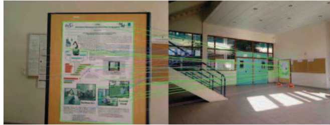
Figure 3: Le résultat expérimental de l'algorithme RANSAC 2-Points.
