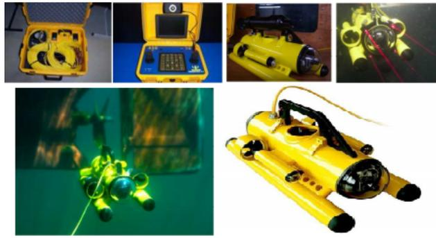
FIGURE 1.11 – ROV-Observer 3.1 de la société SUBSEA TECH
