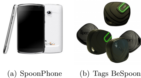
FIGURE 3.4 – Plateforme radio BeSpoon IEEE 802.15.4a (IR-UWB à 3.994 GHz)
