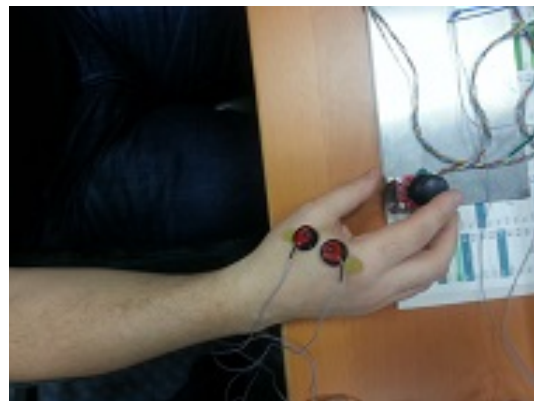
FIGURE 4.10 – Positionnement des électrodes EMG.
