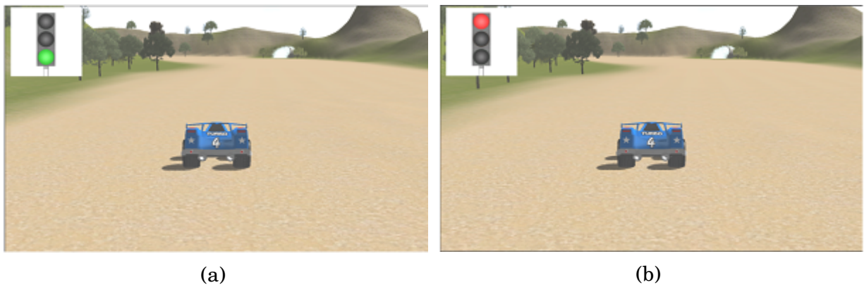
FIGURE 4.13 – (a) Feu vert : possibilité d'envoyer une commande. (b) Feu rouge : période d'inaction.
