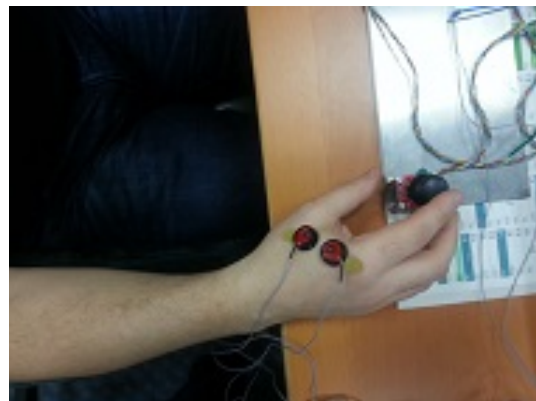
FIGURE 4.10 – Positionnement des électrodes EMG.
