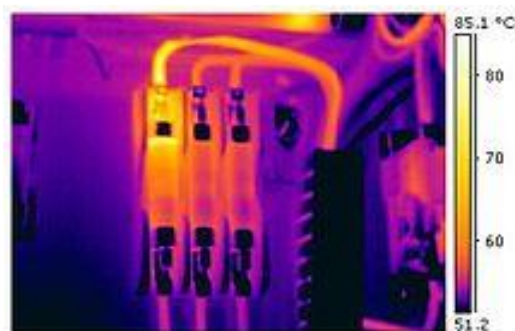
Figure 4. Thermographie de composants électroniques pour détecter les courts-circuits [15]
