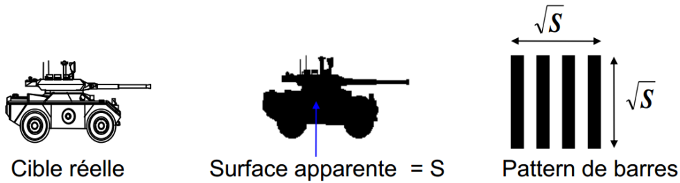
Figure 8. Illustration du principe à la base du critère de Johnson
