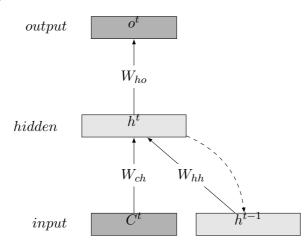
FIGURE 6: Modèle de langage à base de RNN.
