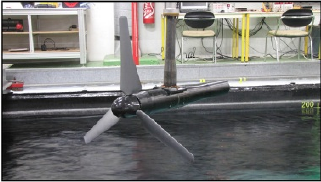
FIGURE 4.7 – Photo de la maquette d’hydrolienne utilisée lors des expériences (IFREMER [1]).
