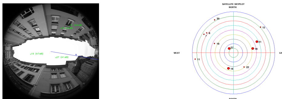
(a) Projection des satellites reçus dans l'image. L'axe Y de l'image est inversé, ce qui fait que l'Est et l'Ouest sont inversés. Le Nord est indiqué en bleu.
