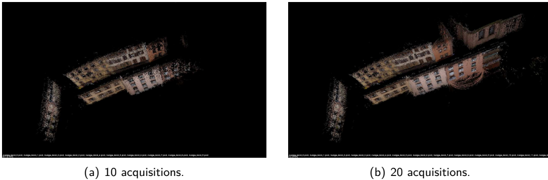
FIGURE 4.21 – Nuage de points après assemblage de 10 et 20 nuages de points 3D successifs (rue du Général Roussel, Belfort, France).
