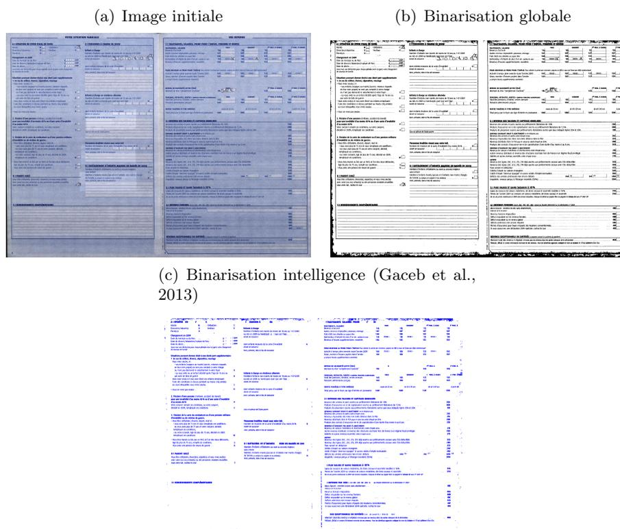
FIGURE 2.12 – Une comparaison entre des résultats de binarisation (a) l'image initiale, (b) une binarisation globale en utilisant Otsu and (c) une binarisation intelligente en utilisant l'approche de l'article (Gaceb et al., 2013)
