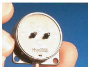
Micropompe médicale à base d'actionneur piézoélectrique http://www.thinxss.com
