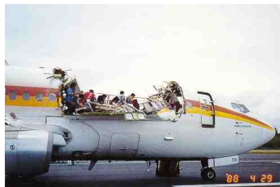
(c) Vol Aloha 243 après qu'une partie de son fuselage se soit arrachée sous l'effet des vibrations causées par les turbulences et les atterrissages répétés (source : http://www.facstaff.bucknell.edu )
