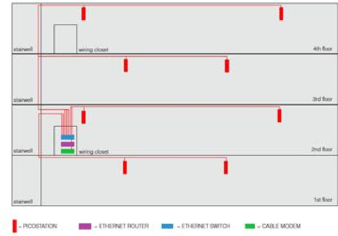
Figure 17 — Emplacement idéal des picostations dans le BAL (3<sup>e</sup> version suggérée).
